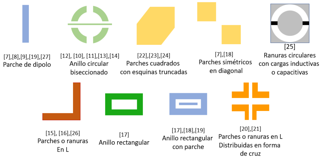
Figura 1.8: Geometrías usuales para polarizadores basados en SSF's.
