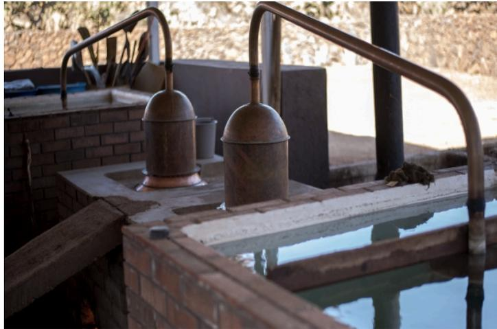
Figura 17. Alambique de cobre con serpentín sumergido en agua
