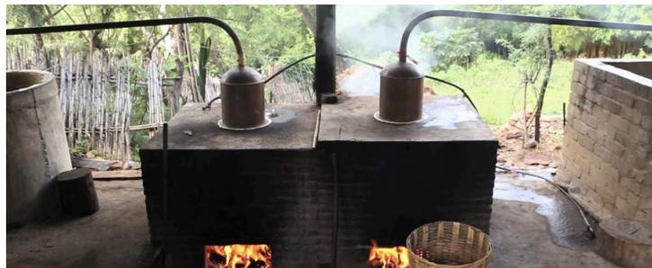
Figura 16. Destilación en alambiques de cobre
