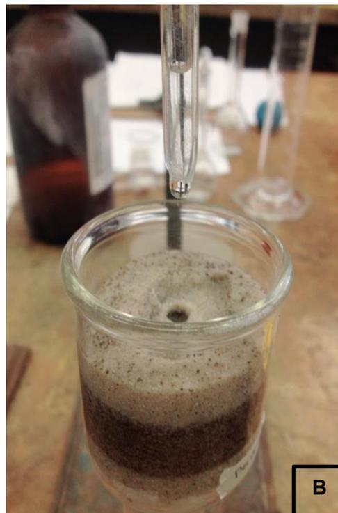
Figura 12. Determinación de las bases intercambiables: equipo de Absorción atómica (A) e instalación del tubo de percolación (B) (Autora).
