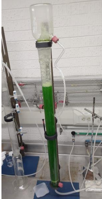
Figura 9: Reactor tipo espumador
