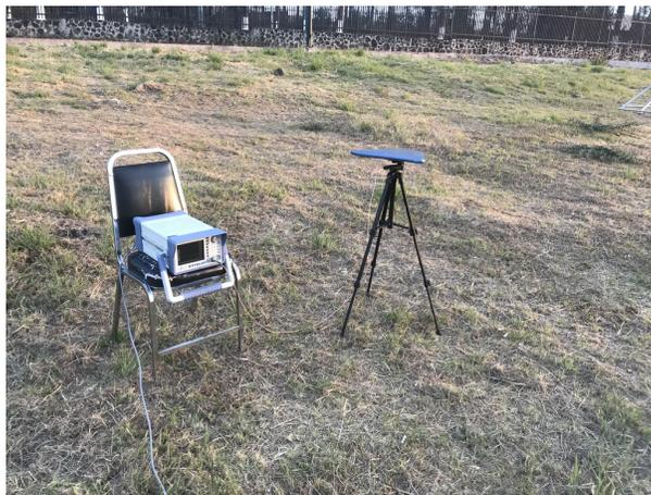
Figura 6.2: Antena y analizador de espectros usados para el barrido direccional.
