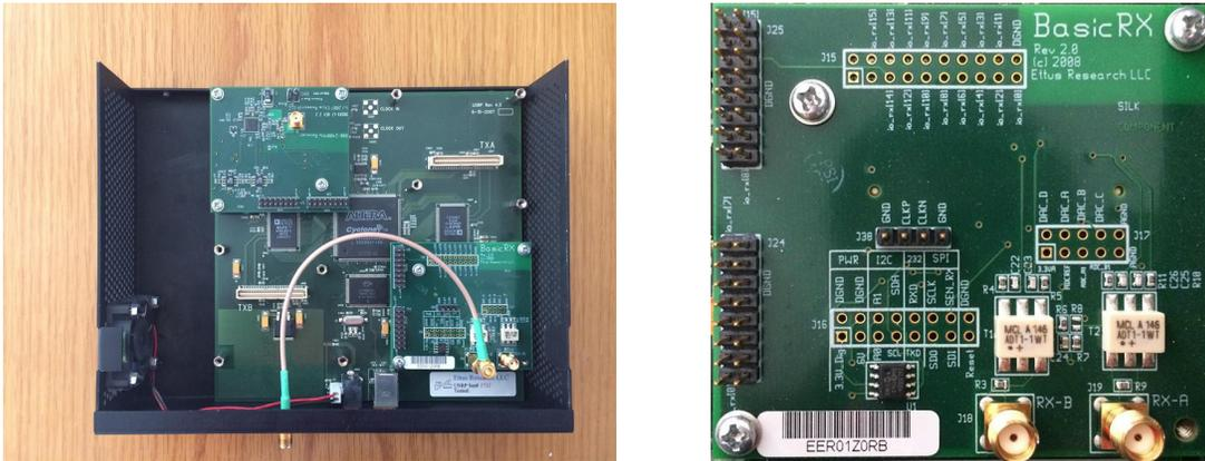
Figura 4.10: USRP-1 (izquierda) y tarjeta secundaria BasicRX (derecha) utilizados.
