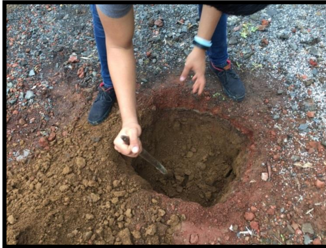
Imagen 3.13. Elaboración de pozo a cielo abierto en estacionamiento 4.
