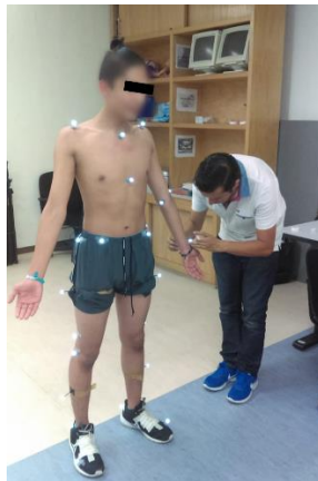
Figura 9. Colocación de marcadores pasivos en practicante de taekwondo por parte de fisioterapeuta para realizar la captura de movimiento.
