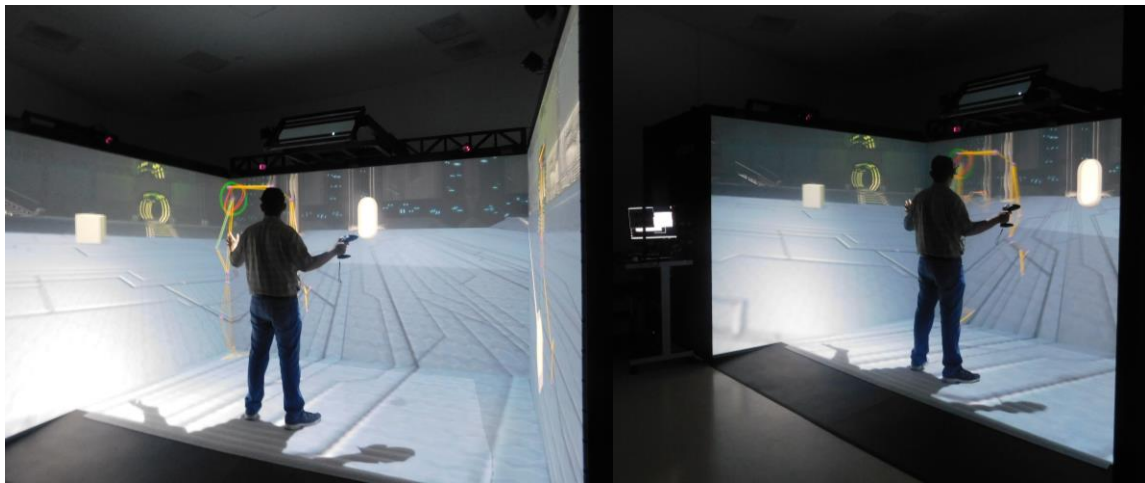
Figura 5. Sistema CAVE del LAVIS siendo utilizado por un usuario para realizar una visualización inmersiva.
