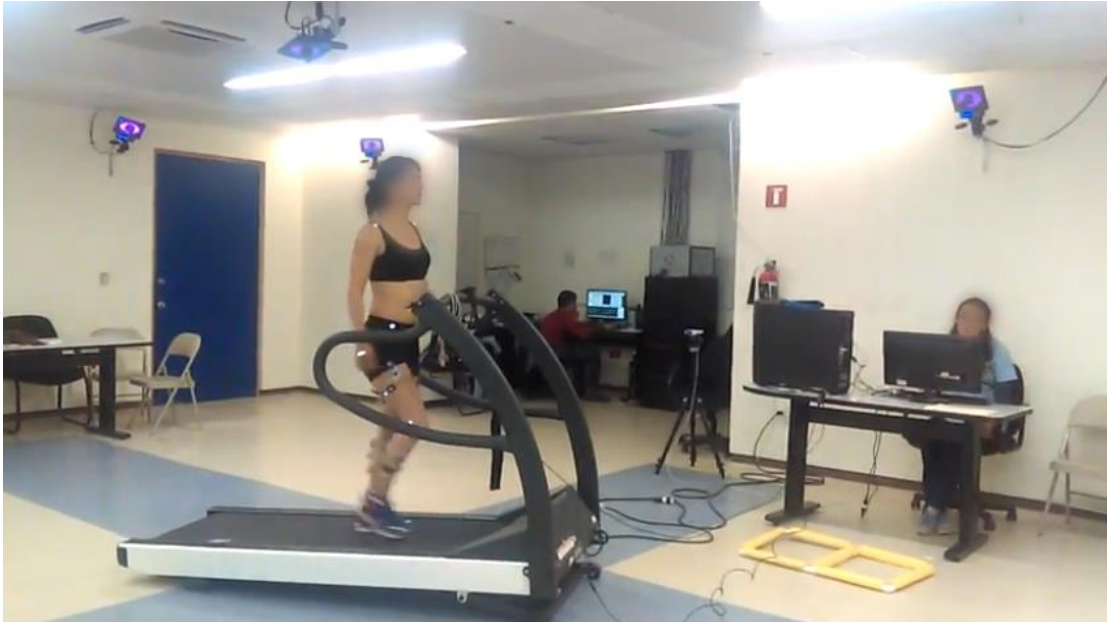
Figura 4. Foto de la unidad de biomecánica de la UNAM Juriquilla donde se realizan las capturas de movimiento con un sistema de localización óptica. En la foto se está realizando un análisis de carrera.
