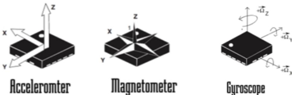
Figura 2.4: Componentes de la IMU.
