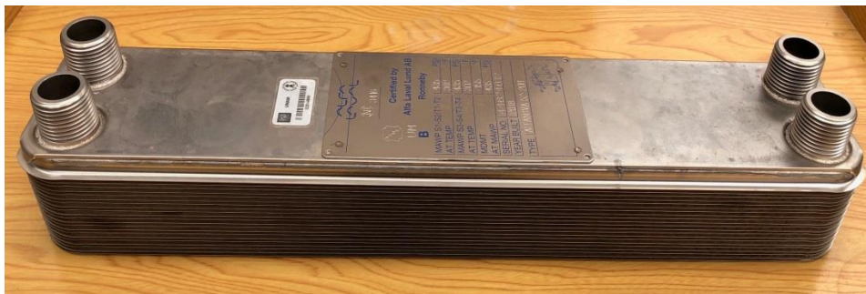
Figura 3.10. Economizador del equipo de refrigeración.
