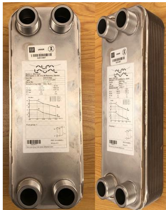
Figura 3.7. Evaporador del sistema de refrigeración.
