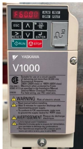
Figura 3.14. Variador de Frecuencia.
