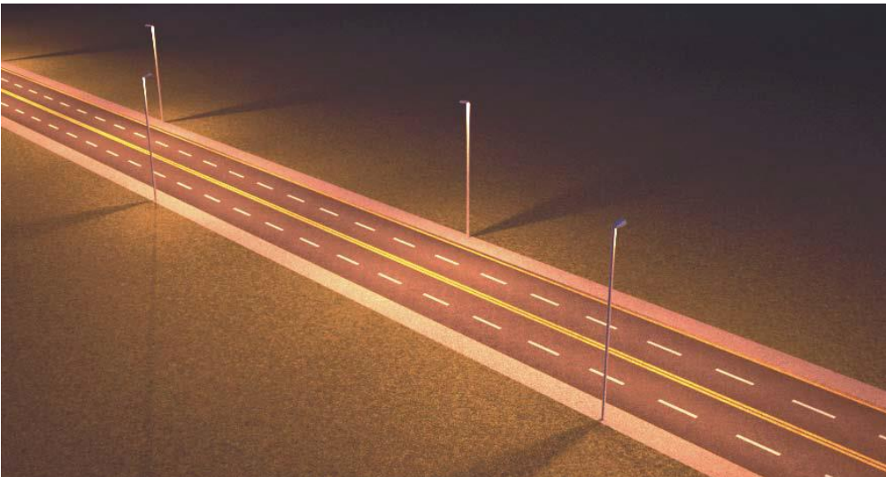
Figura 2.36 Perspectiva de instalación denominada "Tresbolillo" (Fuente Manual de iluminación vial SCyT).
