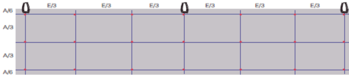
Figura 2.38 Trazado en la carretera de los 21 puntos requeridos para efectuar las Mediciones (Fuente: Tecnología del alumbrado público en las vialidades principales del Estado de México. Ing. A. Horacio López Díaz).
