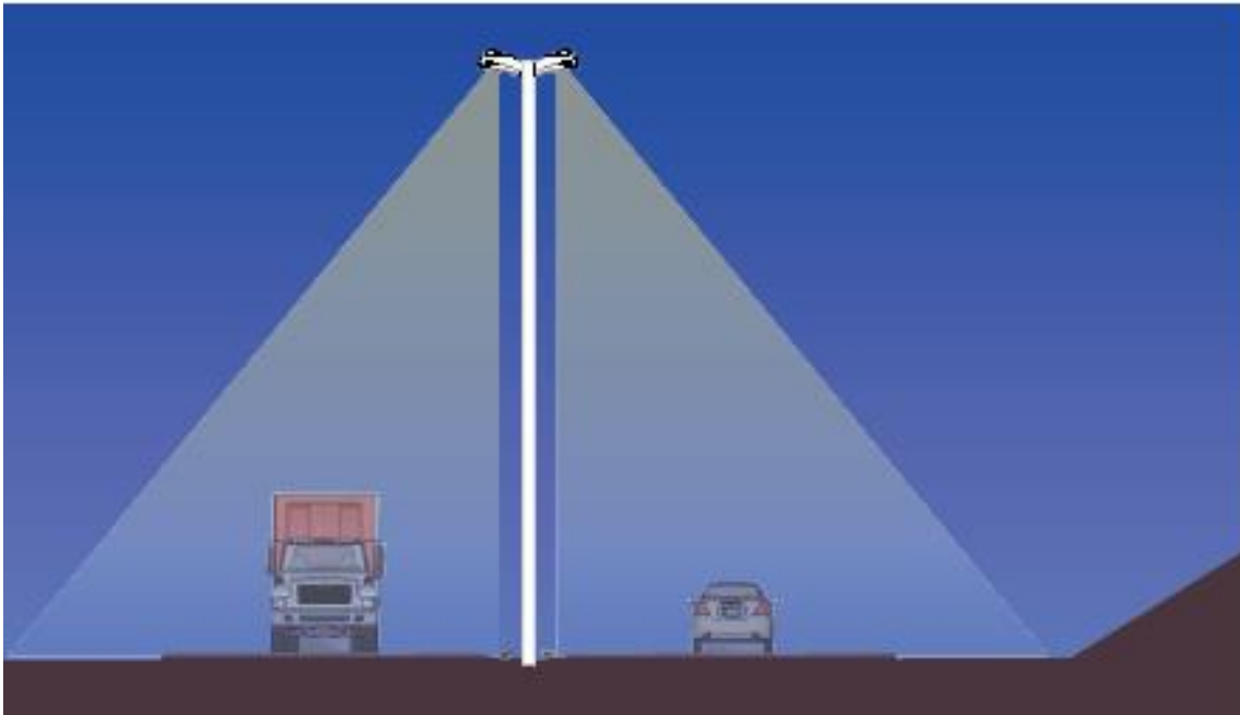
Figura 2.30 Vista en corte transversal de la carretera tipo A4 (un cuerpo con Camellón central) (Fuente Manual de iluminación vial SCyT).
