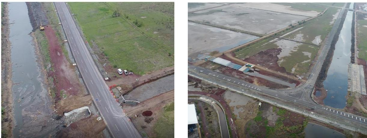
Figura 4.16 Descarga del DPTM-2 al Dren Texcoco Norte, descarga del DPTM-1 PB-3 y su conexión con el Dren Texcoco Norte.
