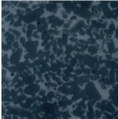
Imagen 28. microestructura de la cerámica in-ceram, alumina (vita) Fuente. Scielo (recuperado integro Martínez Rus, Pradies Ramirez, Suárez García, & Rivera Gómez, 2007)
