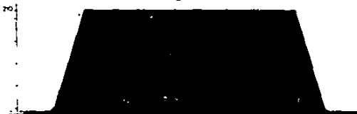
I Ciclo de cierre VULCANIZACION, apertura y acción de extractores correspondiente a nuestras normas EL-19.
