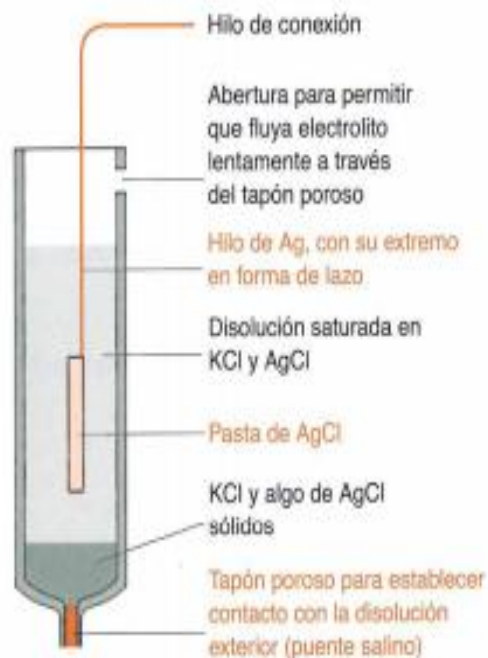
Fig. 1.3.2 Esquema del electrodo de referencia \text{Ag}^0/\text{AgCl}
