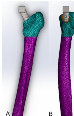
Figura 3.12 A) Vista frontal del ensamble sujeto a análisis. B) Vista lateral.
