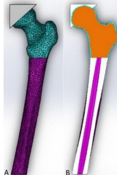
Figura 3.8 A) Ensemble final del fémur donde los colores turquesa y morado representan hueso cortical. B) Corte transversal del fémur donde el color naranja representa hueso trabecular.
