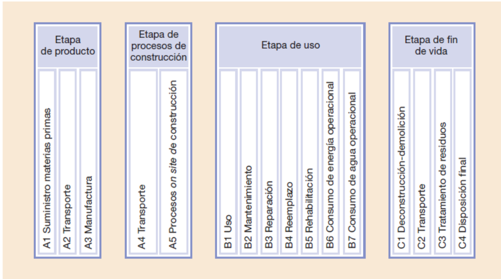
Figura 11. Etapas del ciclo de vida de una construcción según el estándar EN 15643-2 del CEN/TC 350. (Zabalza et al. , 2012)
