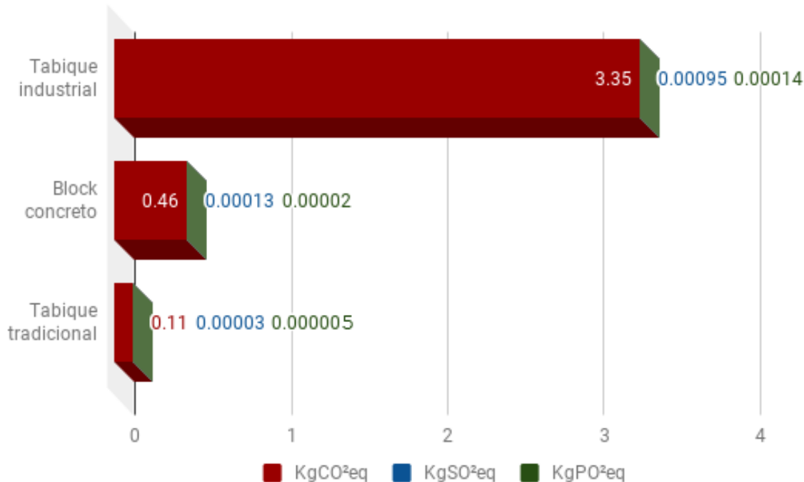
Figura 19. Impactos ambientales derivados del transporte de materiales para 1 m 2 de muro.
