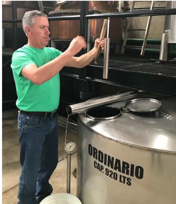
Fig. 20 Utilización del densímetro para comprobar el volumen de alcohol que se obtuvo en la destilación. Fotografía propia.
