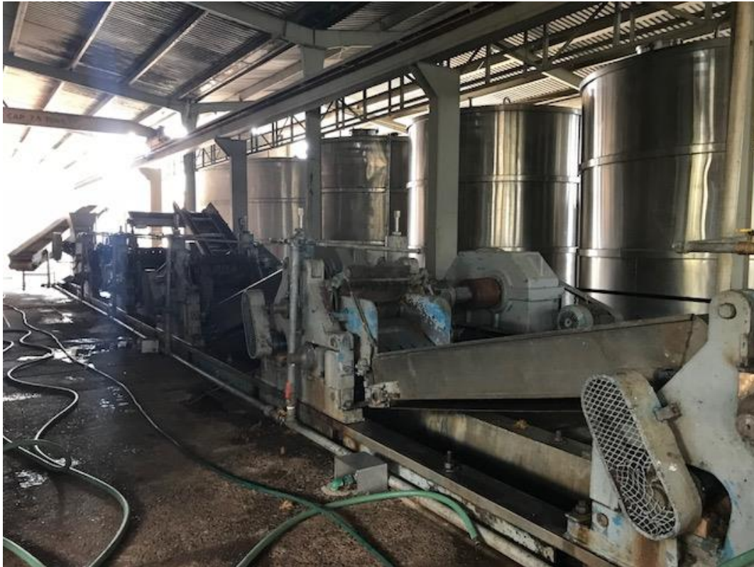
Fig. 17 Desgarradora utilizada para la molienda de las cabezas de agave cocidas, es de creencia popular que el tequila obtenido a partir de este método es de más baja calidad. Fotografía propia.
