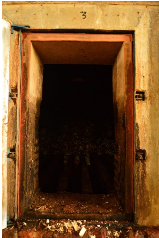
Fig. 16 Horno de mampostería para cabezas de agave. Se le inyecta vapor para la cocción de las cabezas. Fotografía propia.
