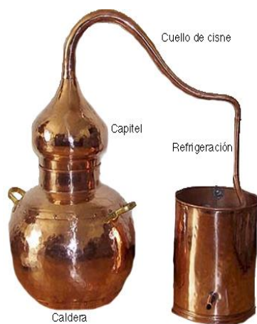
Figura 7. Alambique clásico de cobre, tomado de: https://www.verema.com/blog/licores-destilados/956683-como-funciona-alambique , consulta: 06 de noviembre de 2018.
