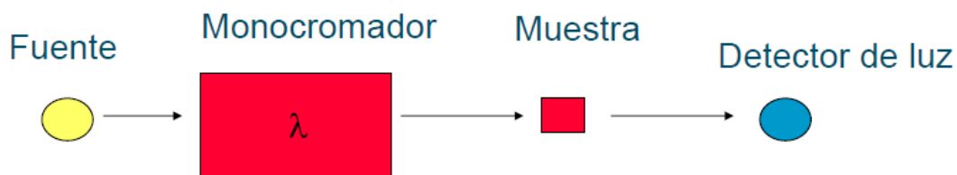
Figura 49 Espectrofotómetro y su funcionamiento
