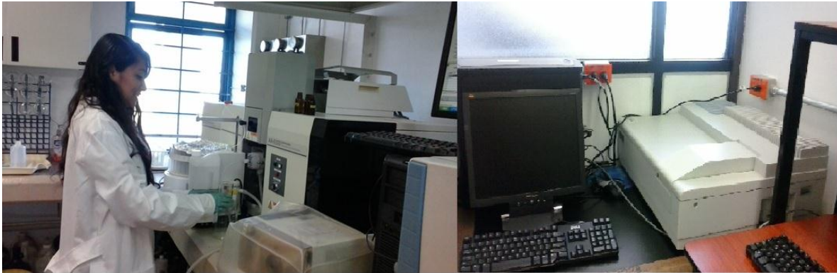
Figura 12. Espectrofotómetro de absorción atómica marca Shimadzu modelo AA-6300 (izquierda) y espectrofotómetro de UV visible marca Perkin Elmer modelo Lambda 25 (derecha).
