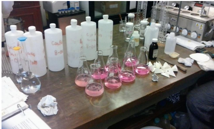
Figura 13. Coloración presente en el método de titulación (colorimetría) para bicarbonatos.
