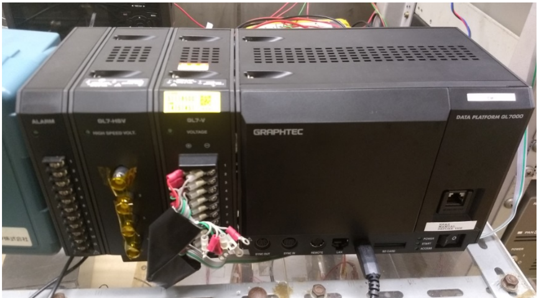
Figura 7.15: Registrador de datos (Data Logger) GRAPHTEC Data Platform GL7000 utilizado en el sistema de medición de empuje del Laboratorio Komurasaki-Koizumi.
