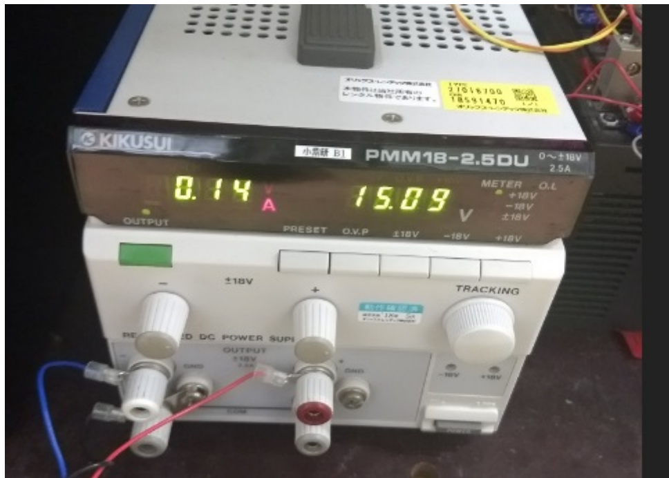
Figura 7.27: Fuente de voltaje KIKUSUI PMM18-2.5DU utilizada en el Laboratorio Komurasaki-Koizumi.
