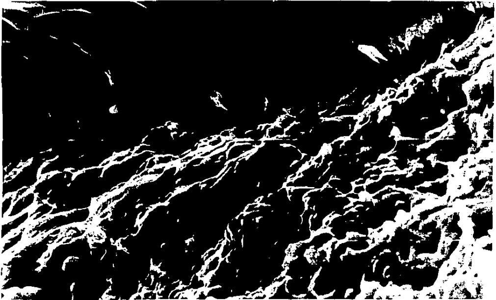
Fig. 12 SEM. Fotografía de la unión de la aleación y la porcelana con fractura completa (Amplificación, X940).
