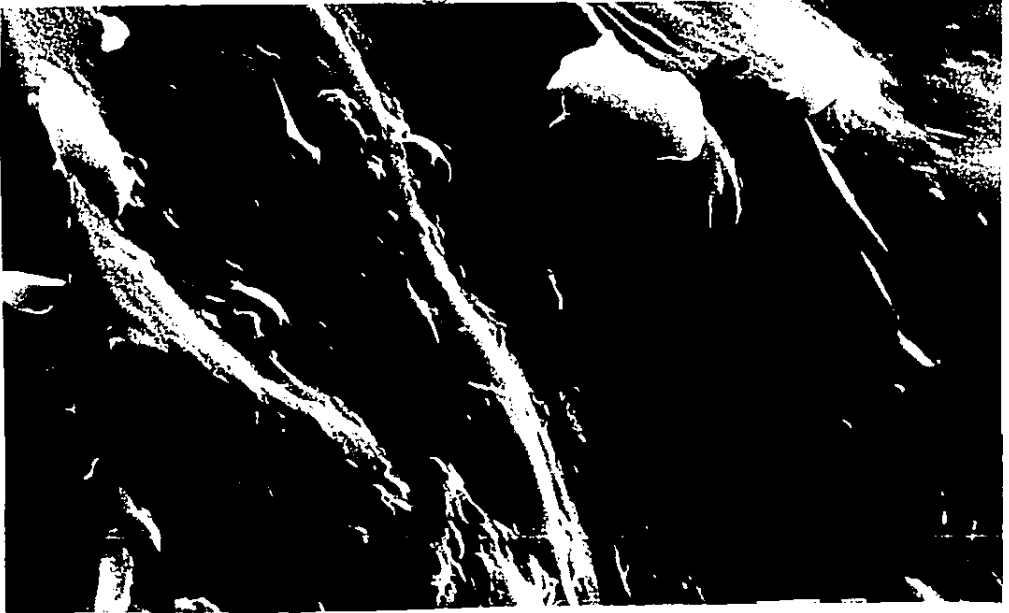
Fig. 11 SEM. Fotografía de base de aleación siguiendo la fractura de porcelana. Las flechas muestran las partículas remanentes de opacador.
