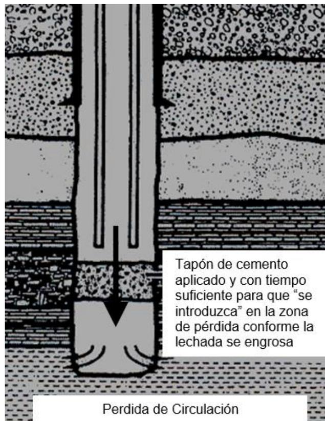
Figura no. 14, "Tapón de cemento para detener la pérdida de circulación", Manual de perforación de pozos PEP.
