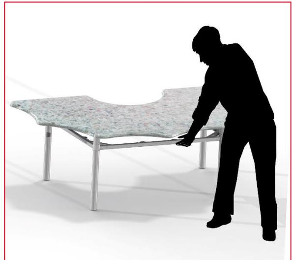
ILUSTRACIÓN 40 CON LAS CUATRO PATAS EXTENDIDAS EL USUARIO DEBE GIRAR LA MESA, COLOCARLA EN EL PISO Y BAJAR LA ESTRUCTURA DESLIZABLE PARA ASEGURAR EL MECANISMO.
