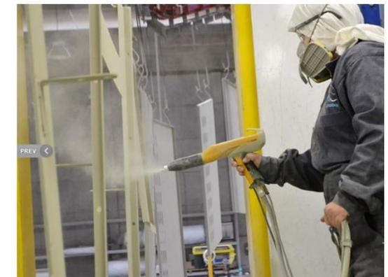
ILUSTRACIÓN 48 APLICACIÓN DE PINTURA ELECTROSTÁTICA
