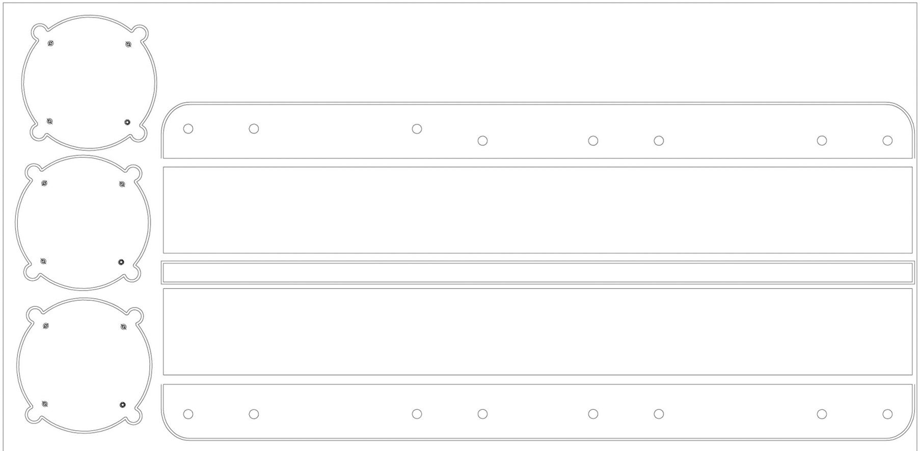
Diagrama de acomodo de piezas: bancos (9 piezas) para corte y perforado en Router cnc
