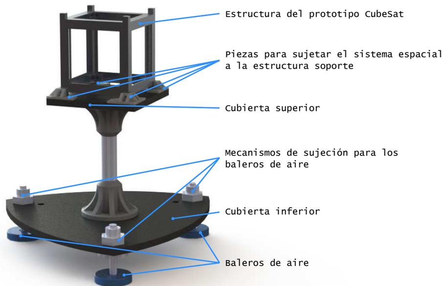
Figura 2.3: Diseño de la estructura soporte. El mecanismo de sujeción de los baleros de aire permite nivelar a la estructura respecto a la mesa de pruebas. La cubierta superior puede modificarse para sujetar a diferentes sistemas espaciales.
