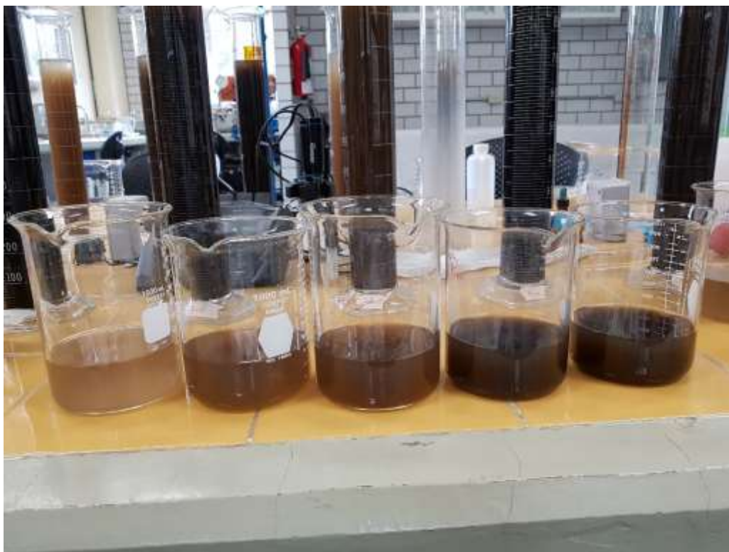
Figura 22. Fracción arcilla recuperada en los vasos de precipitados y el restante (fracción limo) se encuentra en las probetas.
