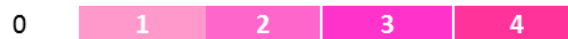
Figura 27. Escala de tipo Linkert aplicado a la intensidad de color de reacción de la fenolftaleína y Fluoruro de sodio. Donde el 0 indica un color de reacción nula, el 1 una reacción baja, el 2 media, el 3 fuerte y el 4 muy fuerte.
