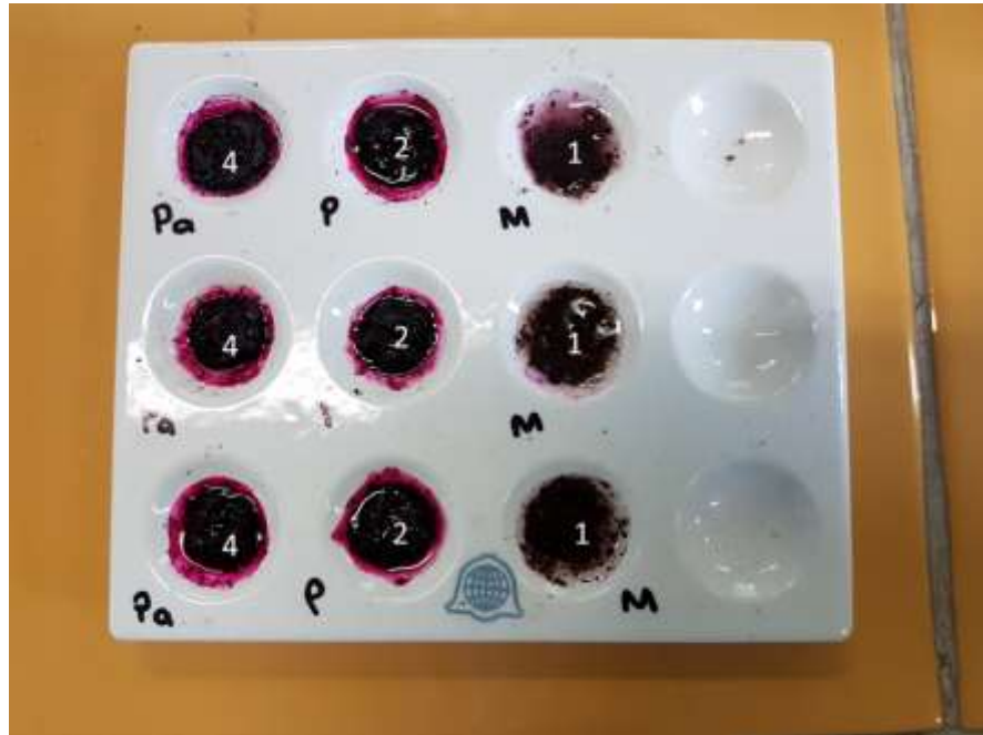
Figura 26. Muestras con la fenolftaleína y fluoruro de sodio a los 10 minutos de reacción.
