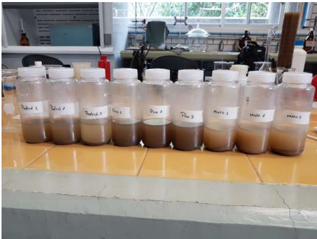
Figura 18. Frascos sellados con Parafilm para agitación durante 12 horas.
