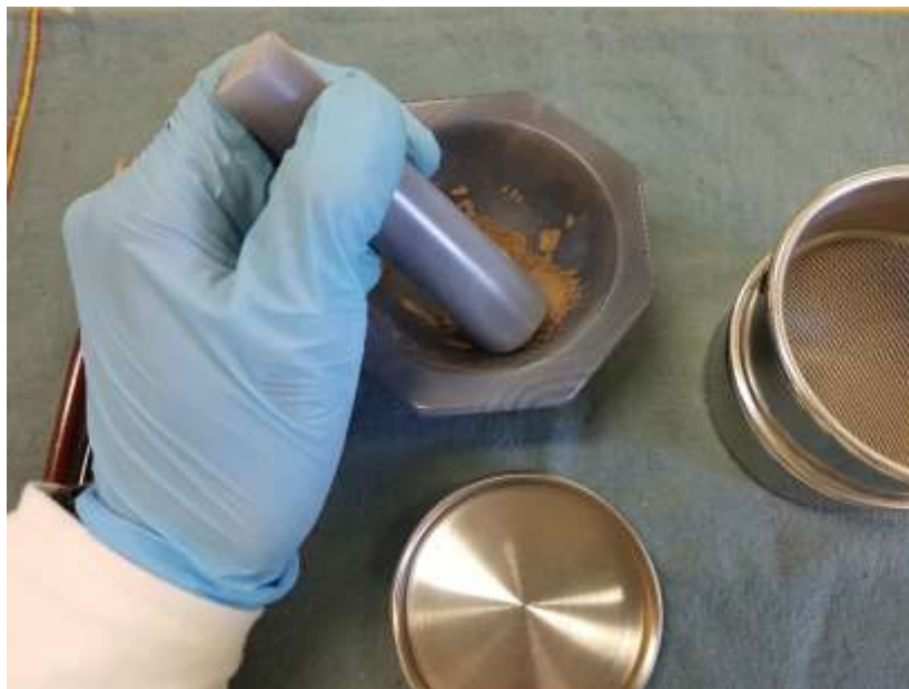
Figura 23. Muestra molida en mortero de ágata y tamiz 80 \mu\text{m} de abertura.
