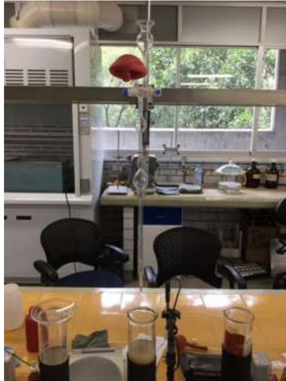
Figura 19. Pipeta de 25 ml que se utilizó para extraer la fracción arcilla
