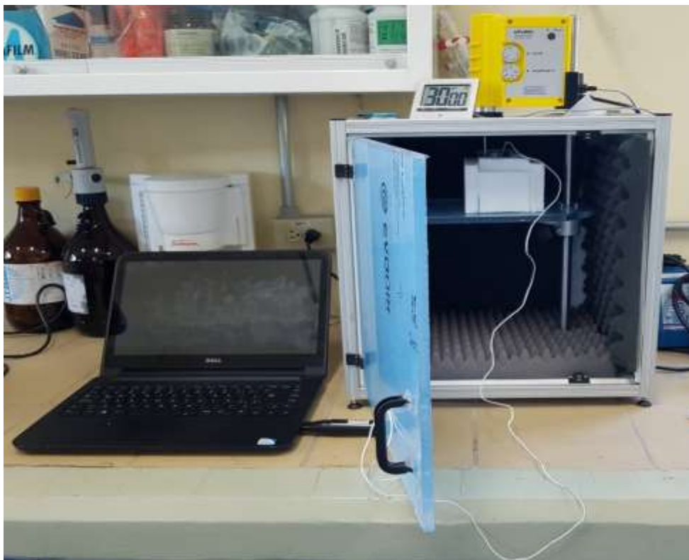
Figura 31 Montaje del desarrollo experimental para medir la temperatura de calentamiento
