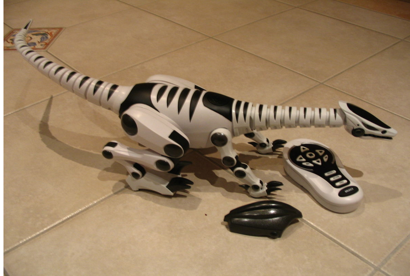
Ilustración 28: Roboreptile. Los sensores infrarrojos están situados en la cabeza, parecen fosas nasales, y en la cabeza también está situado el sensor auditivo.
