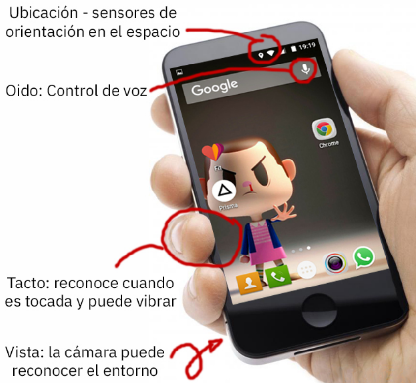
Ilustración 6: Un Teléfono “inteligente” en realidad es una computadora con muchas extensiones de los sentidos humanos, pero con poco espacio para una interfaz WIMP. Las pantallas son físicamente pequeñas ya que se espera que quepan en una mano y sean muy portátiles
