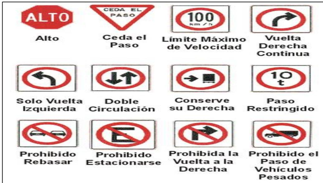
**Imagen 6.5.-** Señalamiento vertical: señalamiento restrictivo.
