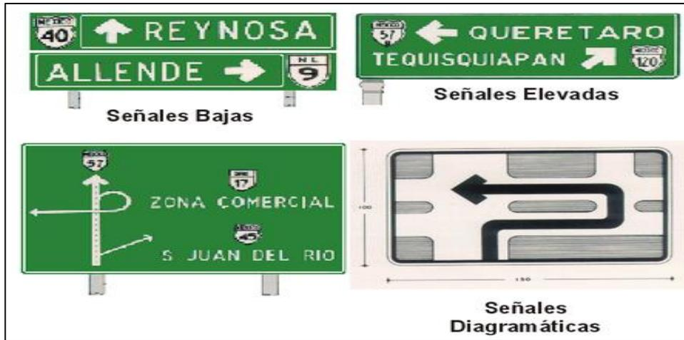
**Imagen 6.7.-** Señalamiento vertical: señalamiento de destino.
