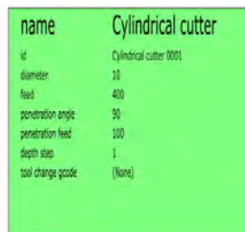
Figura A.15. Ventana donde se cambian parámetros importantes de la herramienta de devastado.
