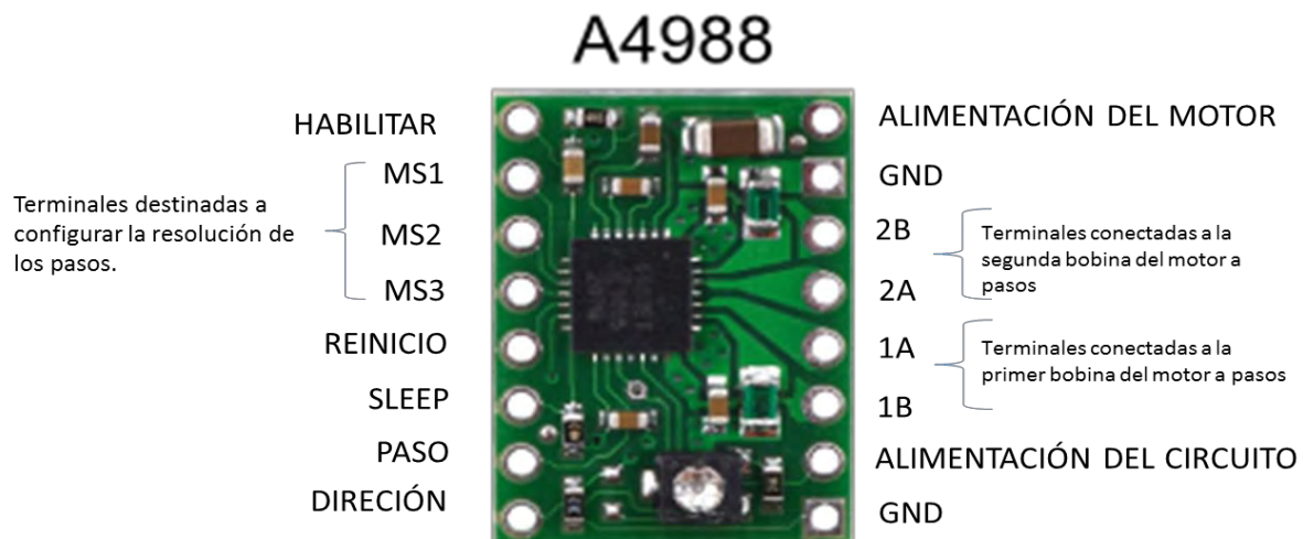
Figura 4.2. Terminales del controlador a4988.
