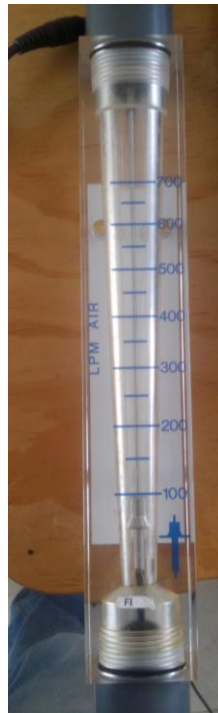
Figura 17 Rotámetro instalado en la planta
