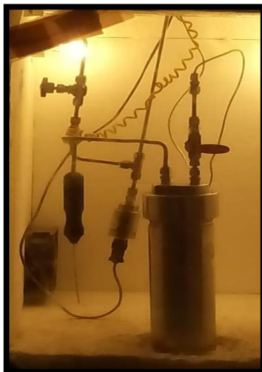
Figura 38. Cámara isotérmica del equipo de fluidos supercríticos
