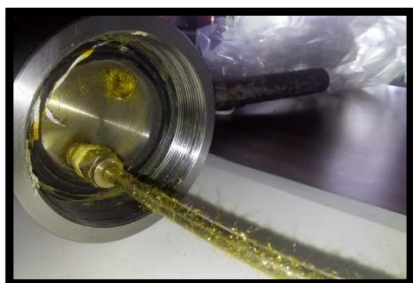
Figura 39. Tapa del reactor y tubo inyector de CO 2
