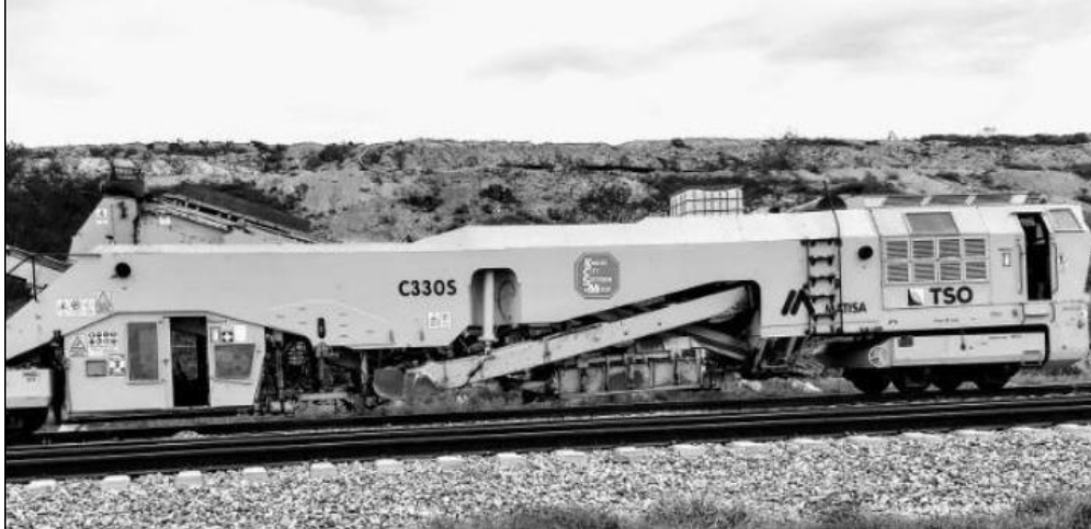
Fig. 37.- Desguarnecedora MATISA modelo C330S.
