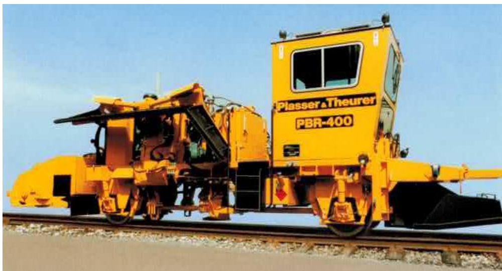
Fig. 34.- Perfiladora de balasto.
