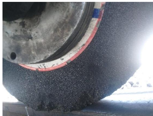
Fig. 35.- Piedra de esmerilado puesta sobre el riel.
