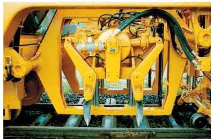
Fig. 33.- Sistema de bateo.
