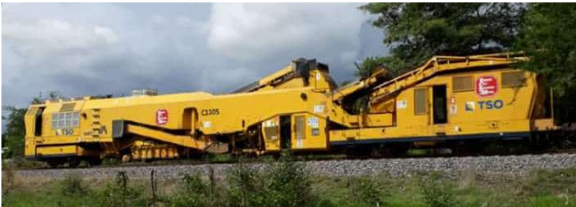
Fig. 31.- Desguarnecedora modelo C330S.
