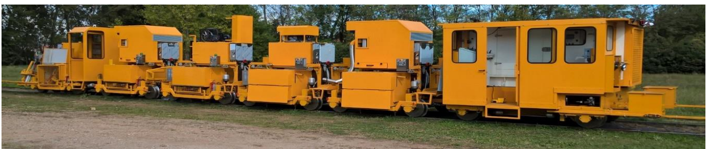
Fig. 36.- Esmeriladora Mecanizada de Riel modelo MS 14S-C.
