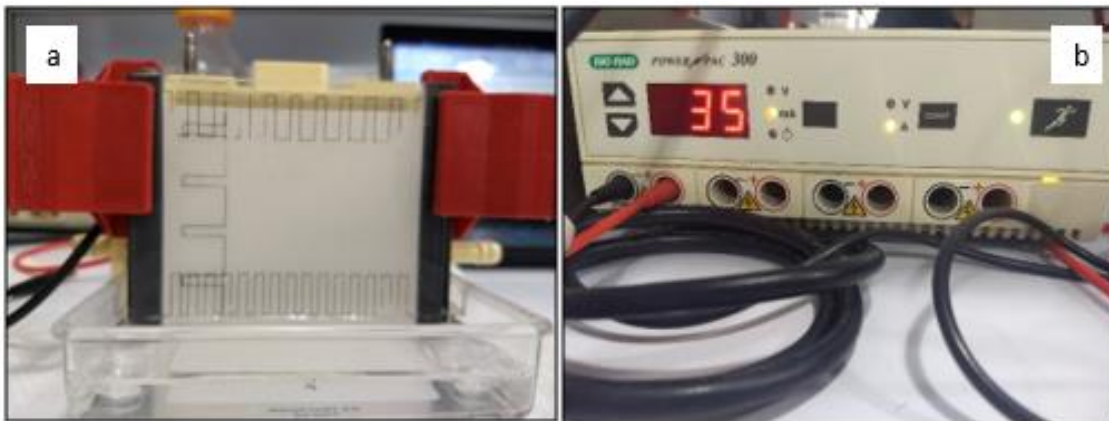
Figura 19. A) Cámara de electroforesis armada. B) Centro de Poder encendido con las condiciones seleccionadas.
