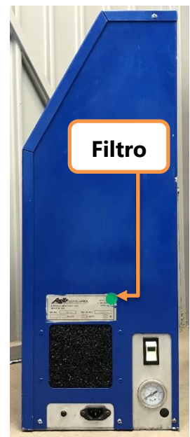
Figura 38. Filtro de partículas gruesas del concentrador de oxígeno.
