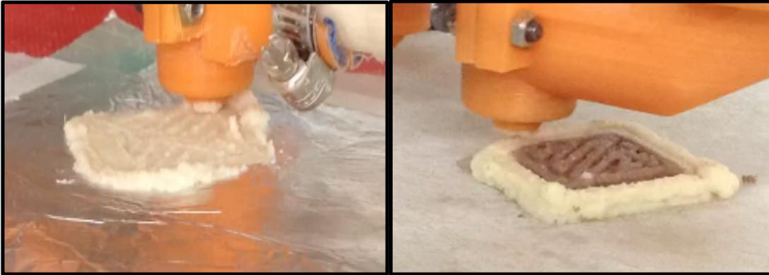
**Figura 65.** El comienzo de la impresión es problemático con superficies muy lisas, mejorando solo hasta cambiar la superficie.
