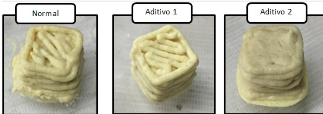
Figura 73. Resultados de extrusión de cubos de 20 mm con diversas formulaciones de masas, se puede apreciar un completo alisamiento de la masa con aditivo 2 añadida.
