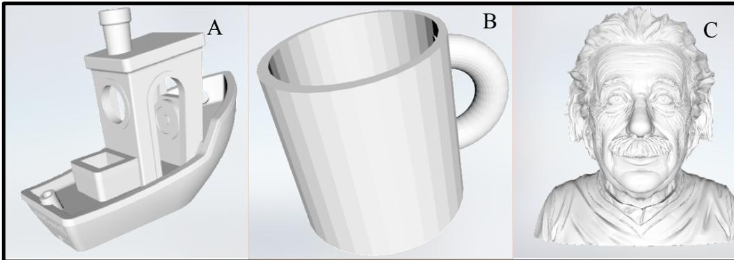
Figura 17. (A) 3DBenchy, geometría que se emplea en la calibración de impresoras; (B) una simple taza; (C) busto de Albert Einstein.
