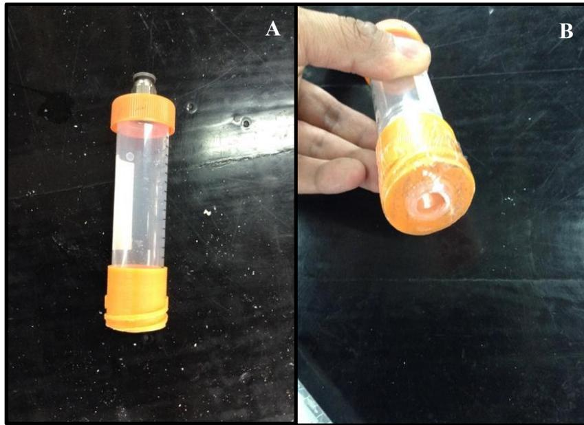
Figura 50. Cartucho con rosca y conexión neumática (A). En la salida se añade un plástico film perforado para facilitar el desalojo de alimento con la presión y evitar que salga o se esponga (B).
