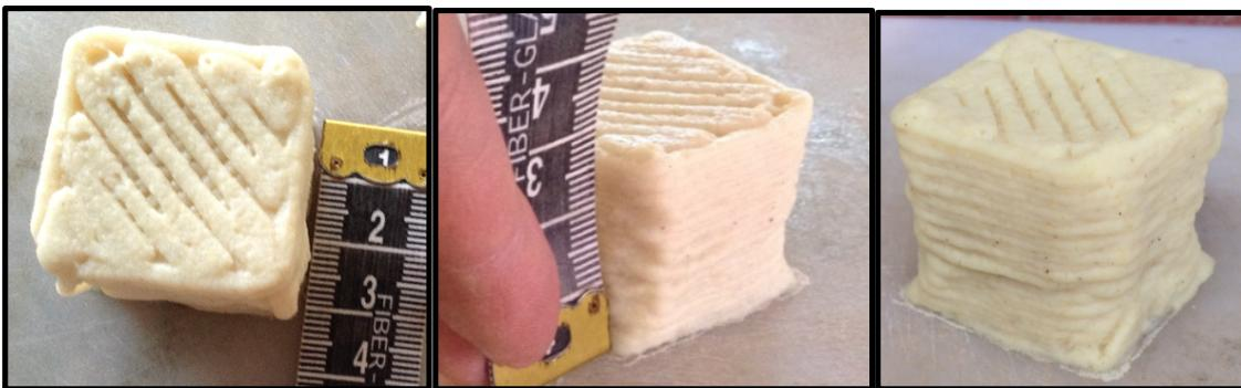
Figura 58. Deformación de la impresión debido al empuje de deposición de las capas.
