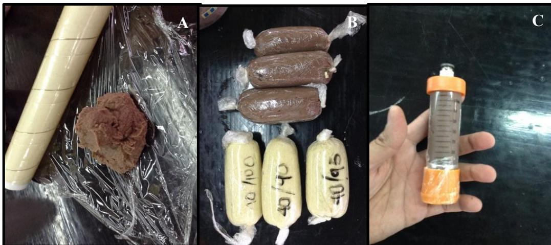
Figura 55. (A) Las muestras se colocaron en papel film y se envuelven, quedando como un “salchichón”(B). Posteriormente los alimentos se insertan con una duya formada por el empaque al cartucho de la impresora (C).
