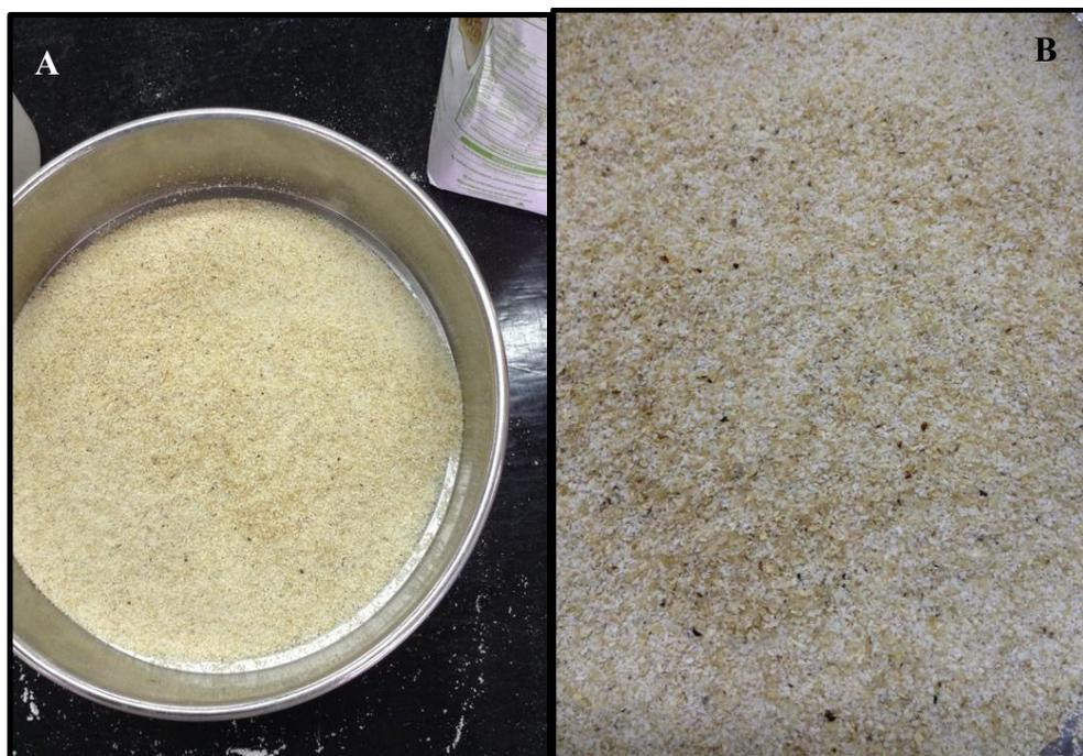
Figura 52. Tamizado de harina de maíz con malla Tyler número 40 (A). Se visualiza la cascarilla y trozos de grano de maíz muy gruesos, estas partículas representaron casi el 25% del empaque y fueron causantes de las obstrucciones (B).
