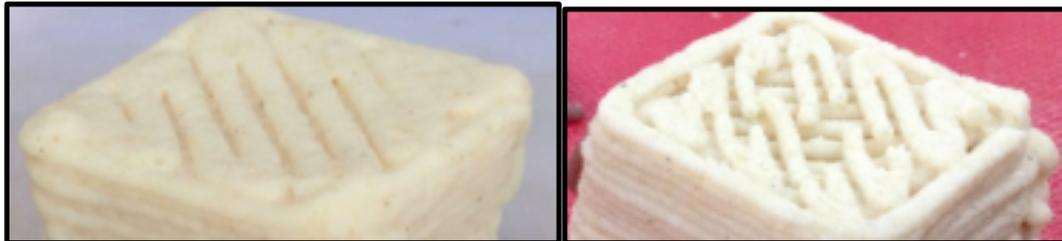
**Figura 60.** Anchura de extrusión excesiva ocasionado por el exceso de presión, la imagen izquierda muestra un filamento grueso de 3 mm que se sale del parámetro y del lado derecho se representa el filamento establecido en los parámetros de 2.2 mm.
