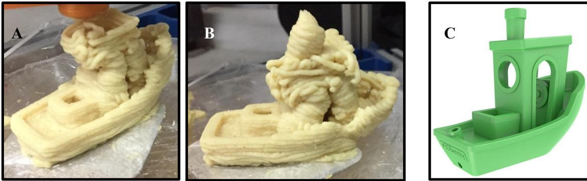
Figura 63. (A) Diseñando un barco 3DBenchy con masa de maíz. (B) Prueba experimental de impresión de barco 3D; (C) El colapso es debido al peso y que no se usa la boquilla adecuada, la cual debe de ser de 1 mm.
