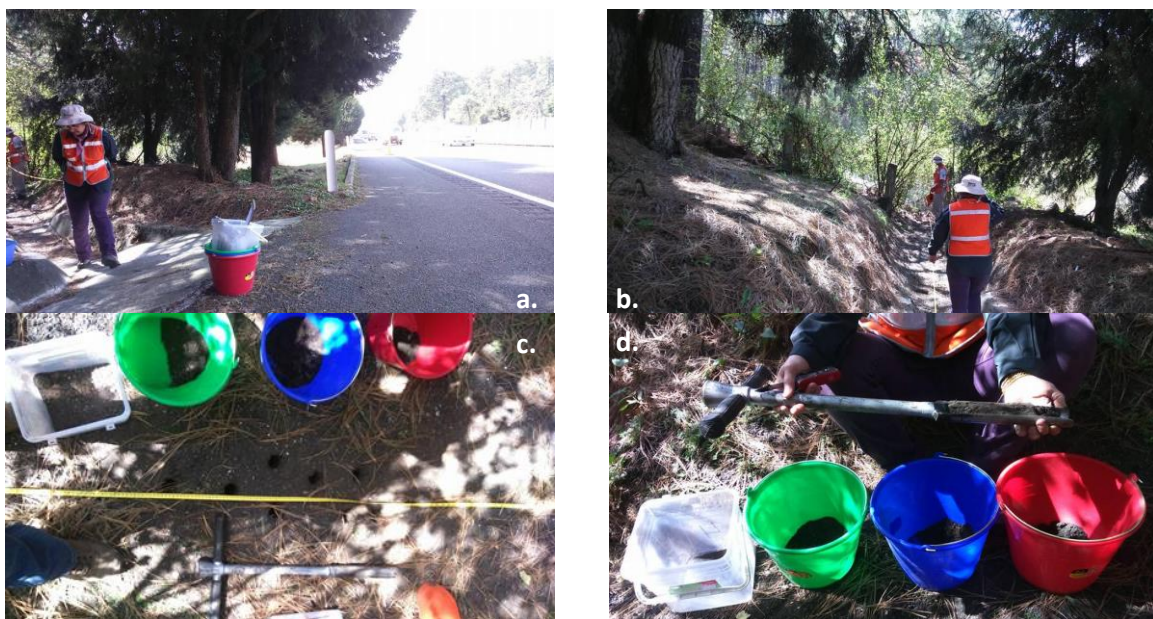
Figura 8: Proceso de toma de muestra. a) Selección del sitio de muestreo (lavadero), b) Toma de medidas desde el bordillo del lavadero y ubicación de puntos de muestreo, c) Toma de muestras con barrena, d) Distinción de profundidades en la toma de muestras.
