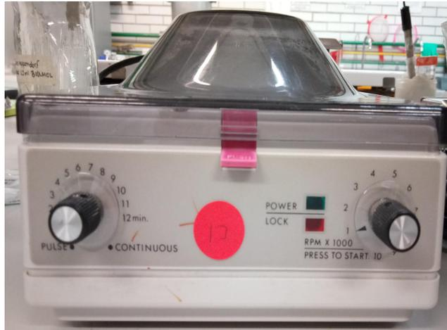
**Figura 22.** Minicentrífuga con los tubos Eppendorf a 3000 RPM
