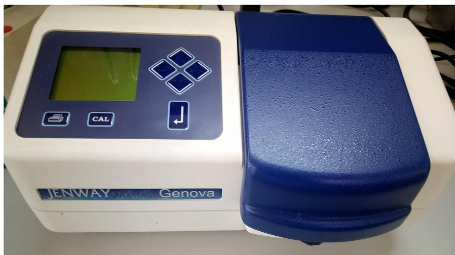
**Figura 20.** Cuantificación de la concentración del ADN en el espectrofotómetro
