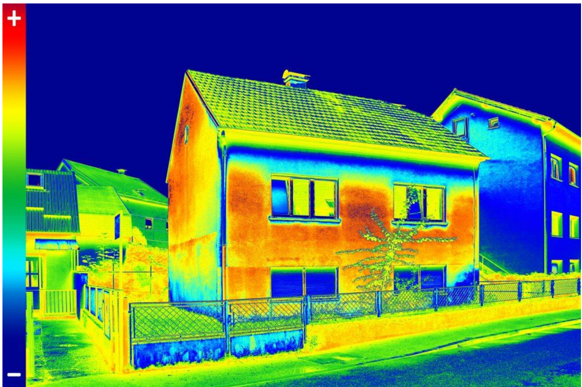
Imagen 39. Foto tomada con Cámara térmica a una casa habitación.
