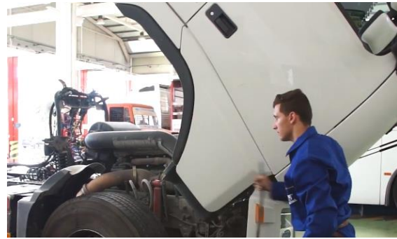
Fotografía 4. Colocar piezas en orden y subir la cabina
