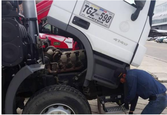
Fotografía 1. Levantar la cabina
