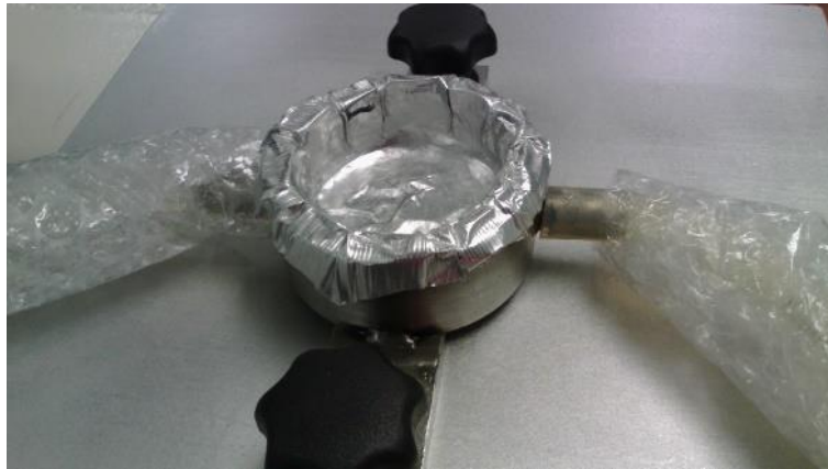
Figura 7.- Recipiente con chaqueta de recirculación de agua.
