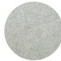
Losa de concreto con revestimiento de granito blanco CEARA de 60x40x2 acabado apomazado unido con Adhesivo Blanco Unión.
