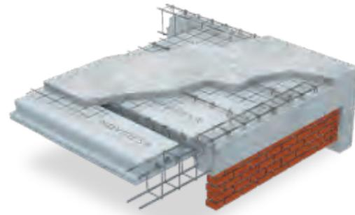
CUBIERTA ALIGERADA CON PANELES AISLANTES DE POLIESTIRENO
