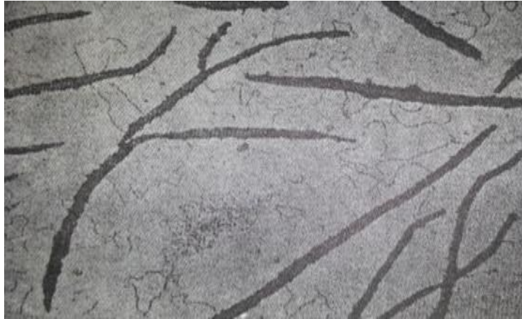
Fig. 3 200X Fundición gris ferrítica. Láminas de Grafito sobre un fondo blanco de cristales de Ferrita.
