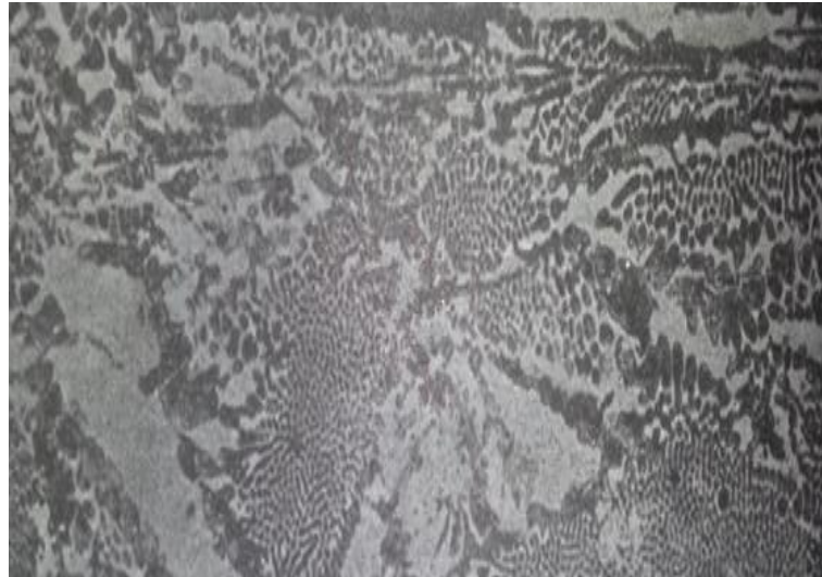
Fig. 2 Microestructura de una fundición blanca hipereutética. A 200X Se observan importantes masas blancas de cementita hipereutética. También se observan agrupaciones pseudoeutéticas derivadas de la lebedurita que están constituidas por pequeñas partículas negras de perlita sobre un fondo blanco de cementita.
