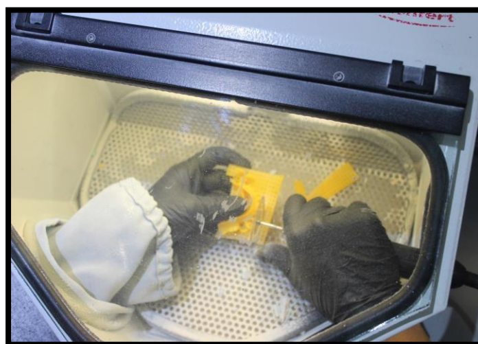
Figura 62 Fase de recortado de la impresión. F.D.
