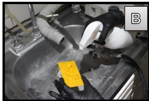
Figura 61) Baño de alcohol en tina ultrasónica. B) Rosear la impresión 3D con alcohol. F.D.
