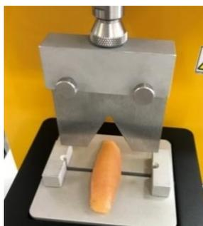
**Figura 8.** Prueba de resistencia al corte de fajitas de pollo.
