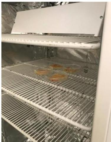
*Figura 11.* Cámara de luz ultravioleta y posición de las muestras.
