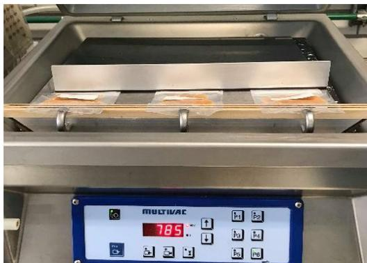
**Figura 6.** Envasadora *Multivac*®.
