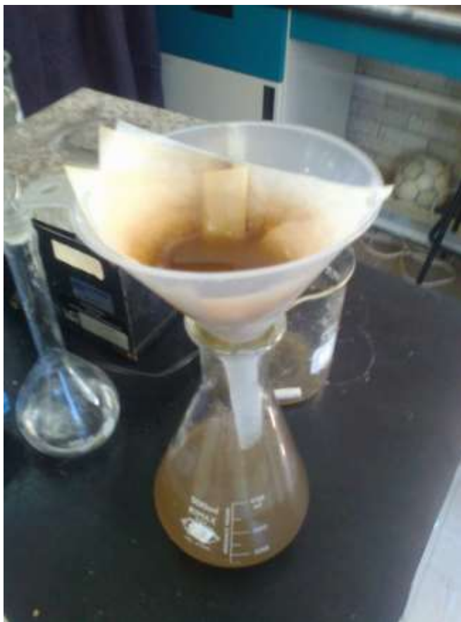
Figura 8. Obtención de Zn^{2+} y Mn^{2+} de una pila alcalina.
