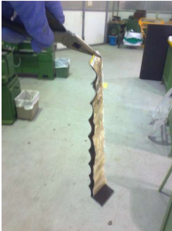
Figura 10. Desmantelamiento de una pila Ion-Li.
