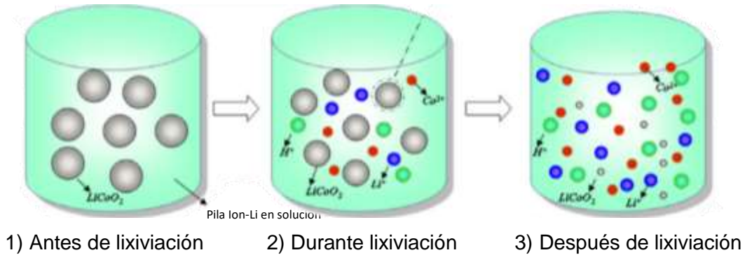
Figura 12. Lixiviación del contenido de una pila de \text{LiCoO}_2 (Dorella and Mansur, 2007)
