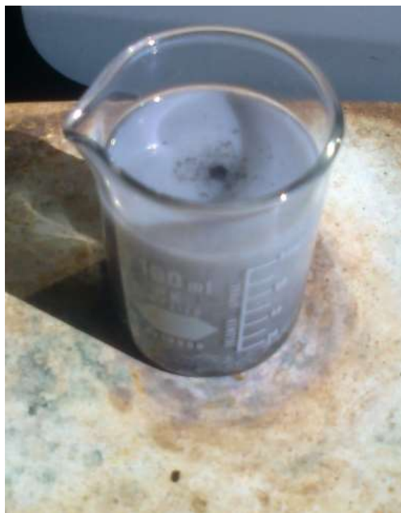
Figura 7. Lixiviación del contenido con ácido sulfúrico, pila alcalina.
