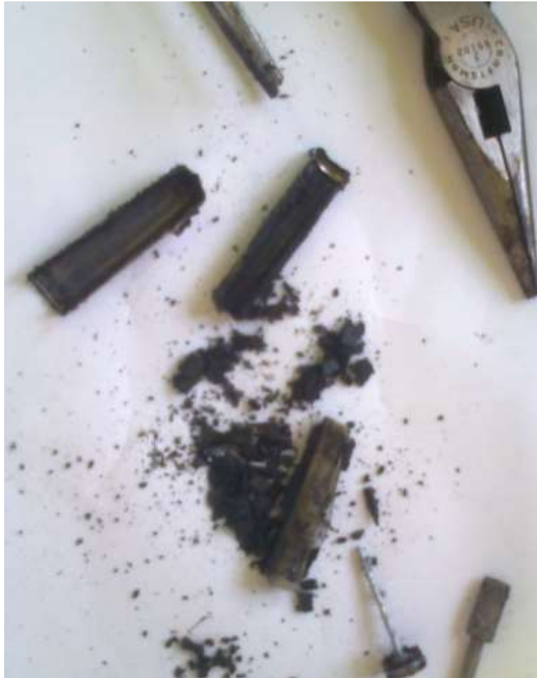
Figura 5. Desmantelamiento de una pila alcalina.
