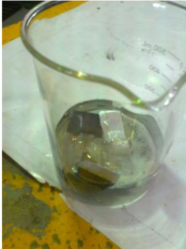
Figura 11. Estabilización del electrolito de una pila Ion-Li
