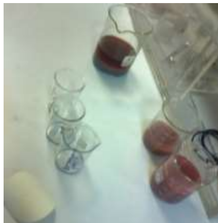
Figura 13. Lixiviación del contenido con ácido sulfúrico de una pila Ion-Li
