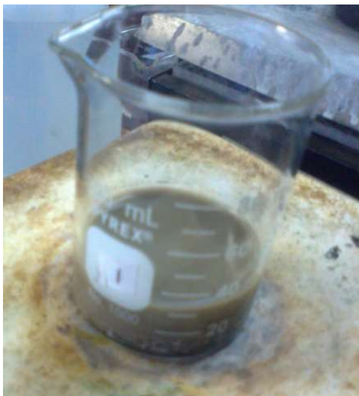
Figura 6. Separación del electrolito, pila alcalina.
