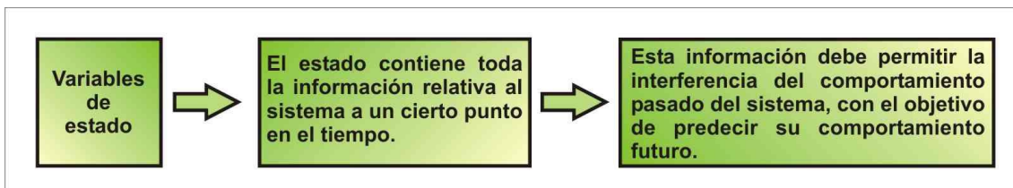
Figura 2. 1 Variables de estado del filtro de Kalman.
