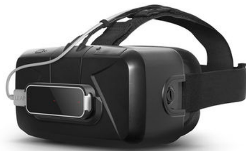
(b) Leap Motion TM incorporado a un HMD. [15]
