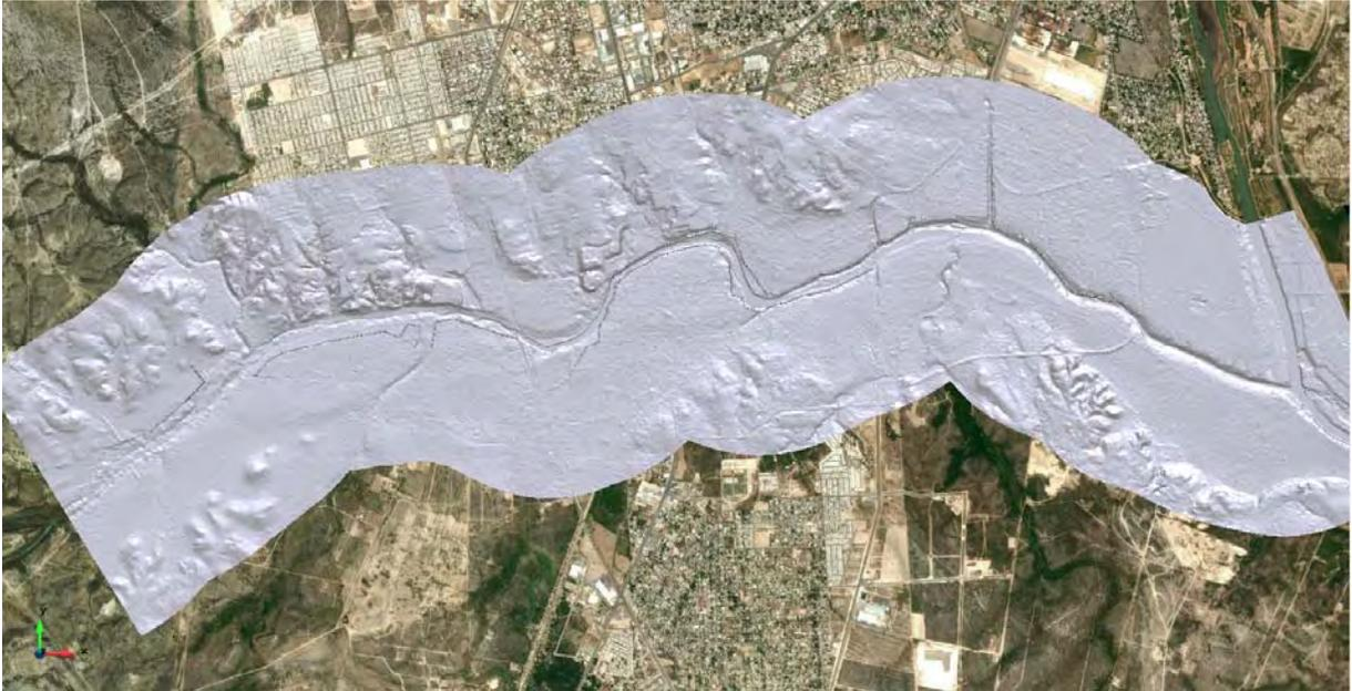
Imagen 4.54 – Distribución de bordos de protección, efectuados mediante la edición de la malla no estructurada, para la combinación con presa rompepicos.
