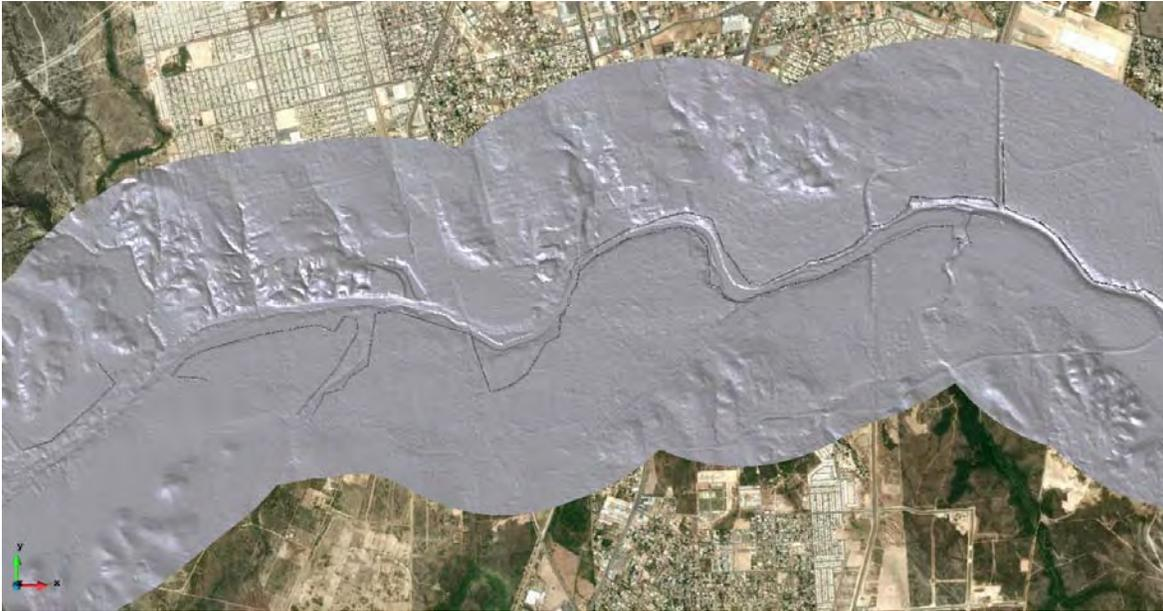
Imagen 4.49 – Distribución de bordos de protección, efectuados mediante la edición de la malla no estructurada.
