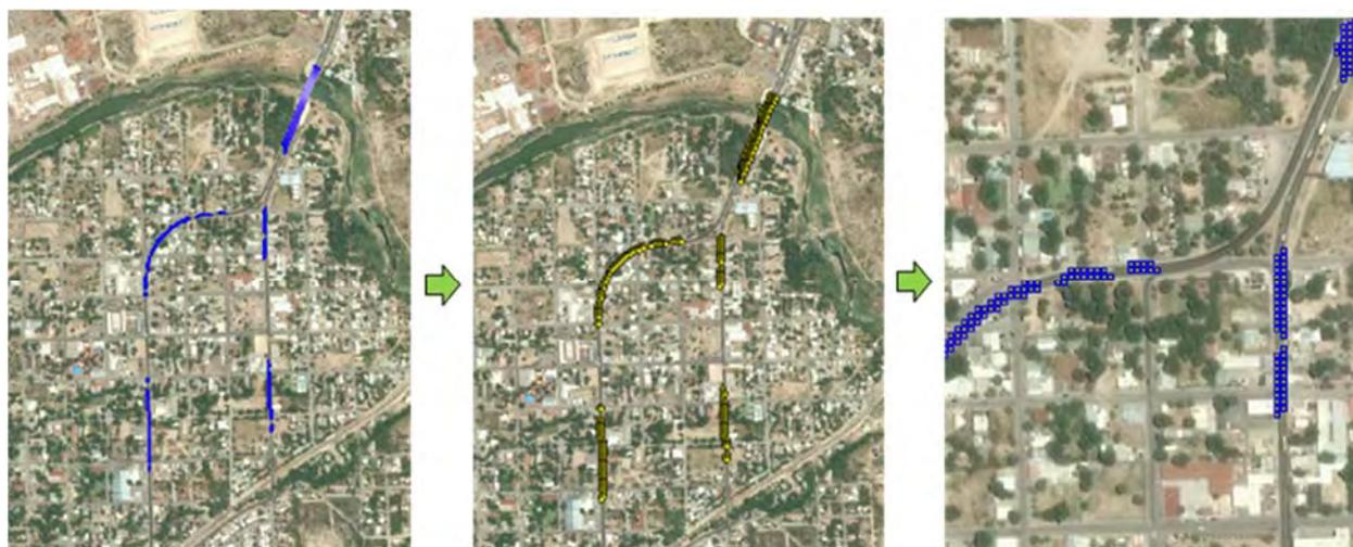
Imagen 4.38 – Proceso para la determinación de la superficie de carreteras afectadas.
