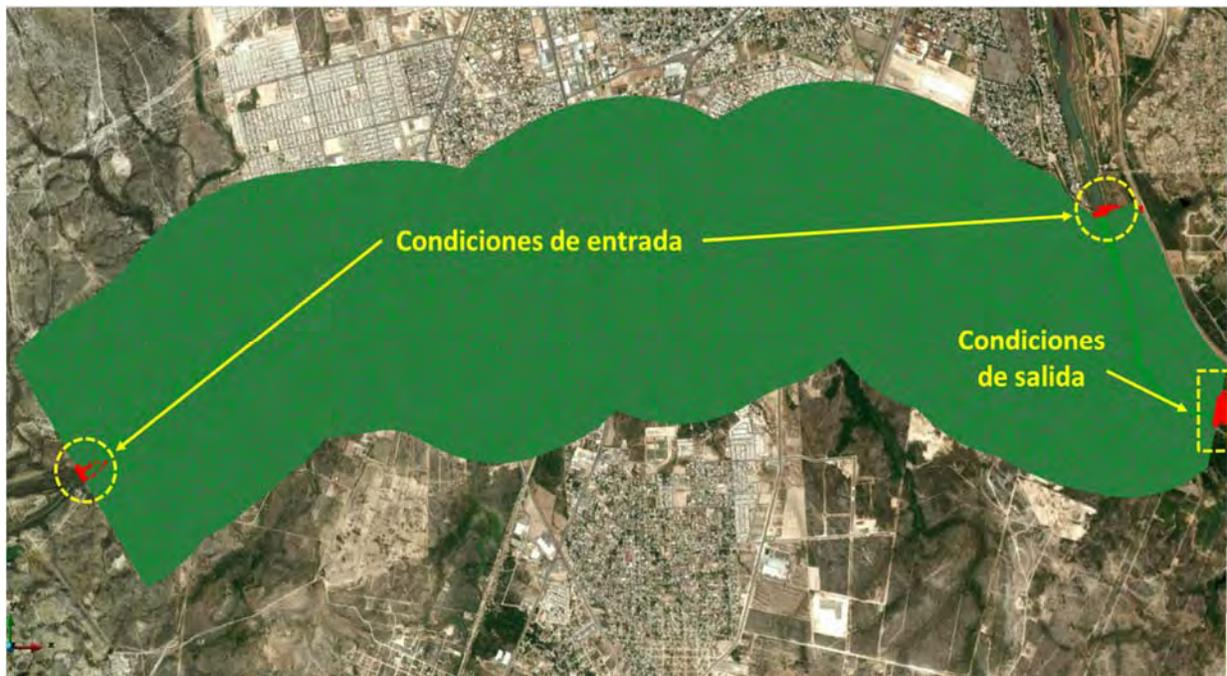
Imagen 4.10 – Determinación de condiciones de frontera en el modelo Iber.
