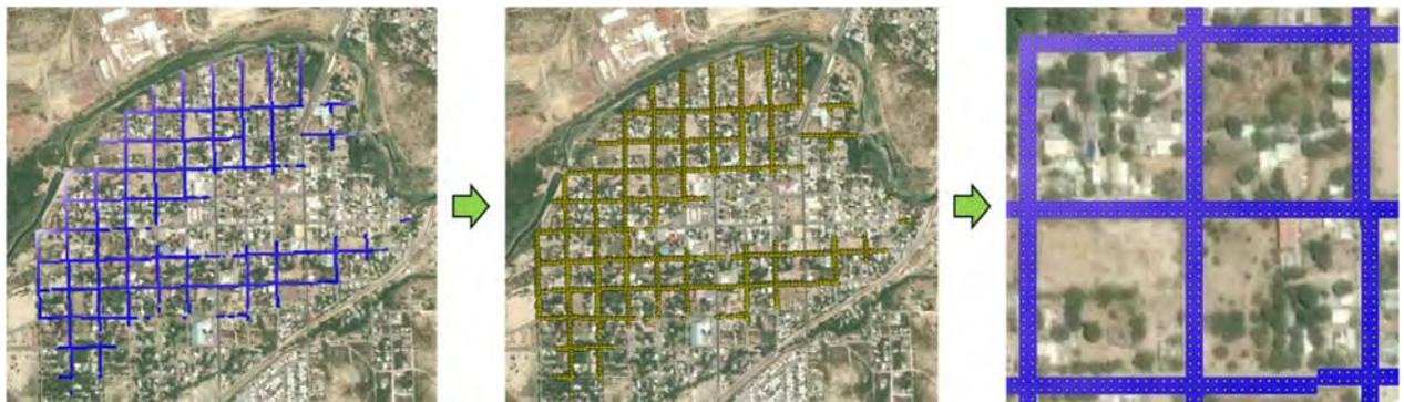
Imagen 4.36 – Proceso para la determinación de la superficie de calles afectadas.
