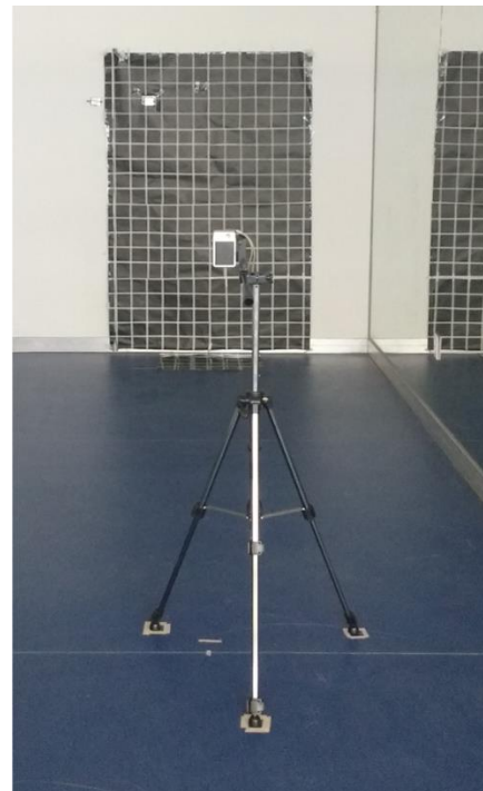
Figura 4: Posicionamiento de la cámara sobre el tripe en posición vertical a una distancia de 400 cm de la pared de evaluación y altura de 120 cm encima del suelo. Fuente directa
