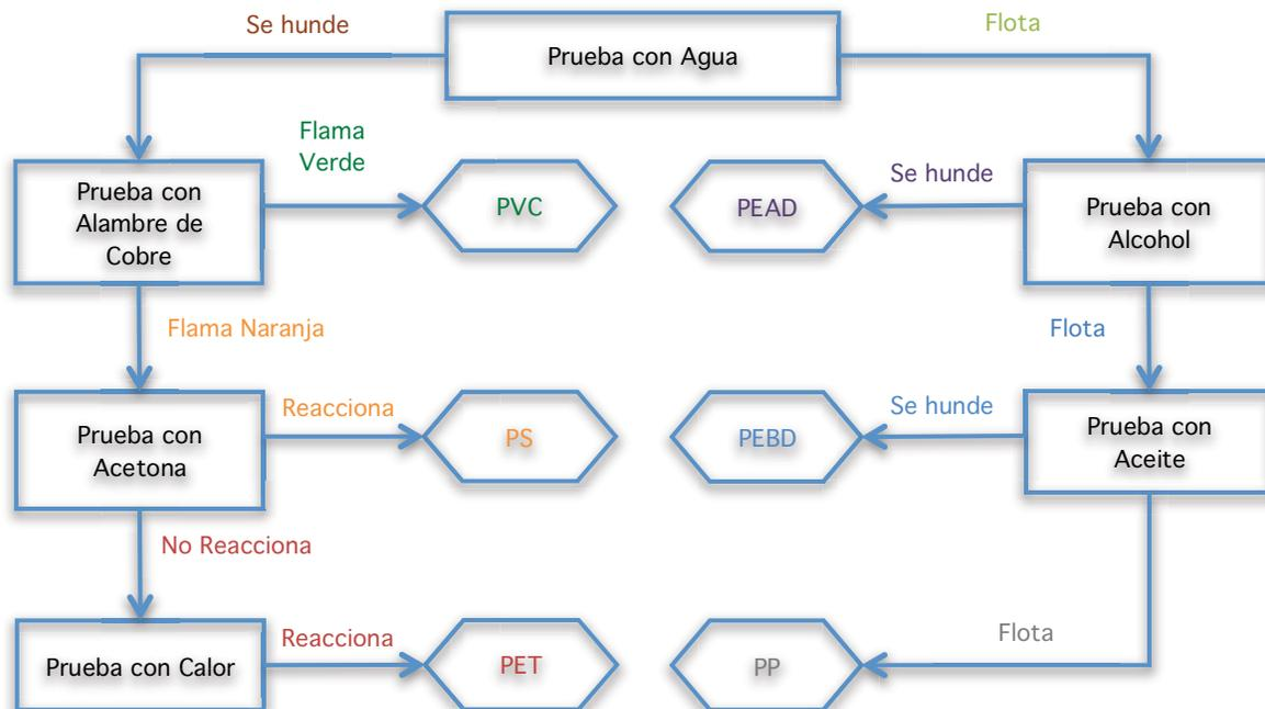
Figura 19. Diagrama de flujo para identificar los termoplásticos mas comunes.
