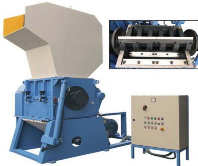
*Figura 20. Molino de cuchillas giratorias.*
