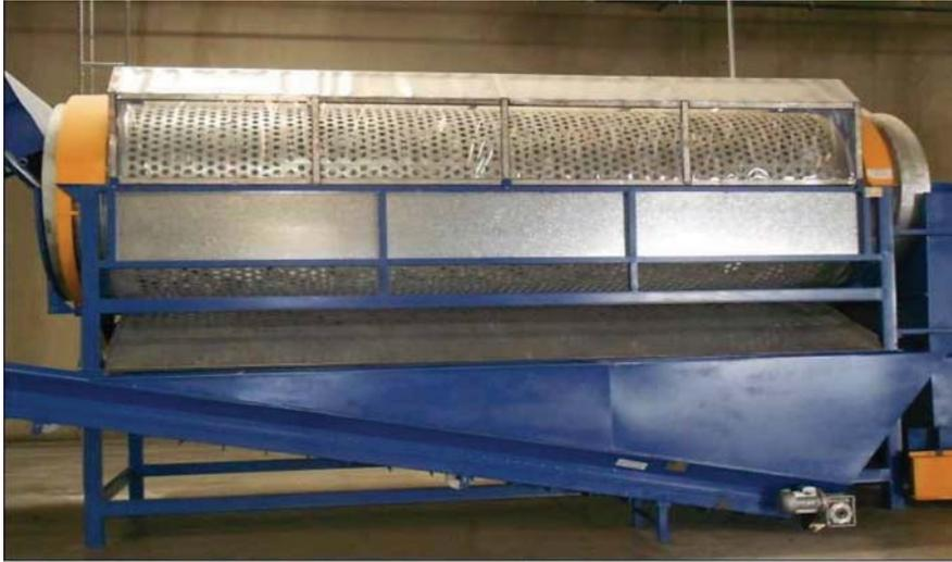
*Figura 16. Criba cilíndrica o Trommel.*
