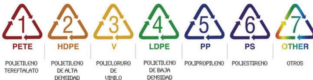
*Figura 12. Códigos de identificación de envases de plástico para reciclaje.*
