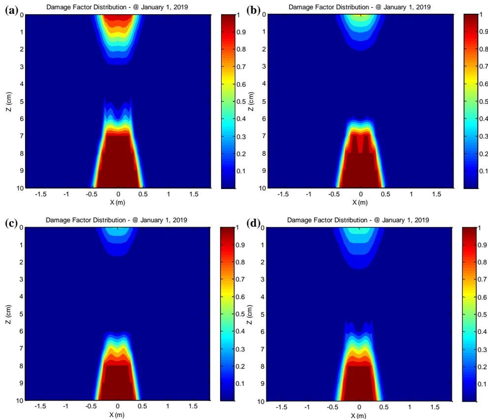
**Figura 5-19.** Contornos de daño de la sección de estudio para 7 años de simulación obtenidos con FlexPAVE™ usando un eje de diseño con una carga de 52 kN para las mezclas fabricadas con los asfaltos: (a) PG64-16, (b) PPA76H-16, (c) TER76E-22 y (d) SBS76V-22
