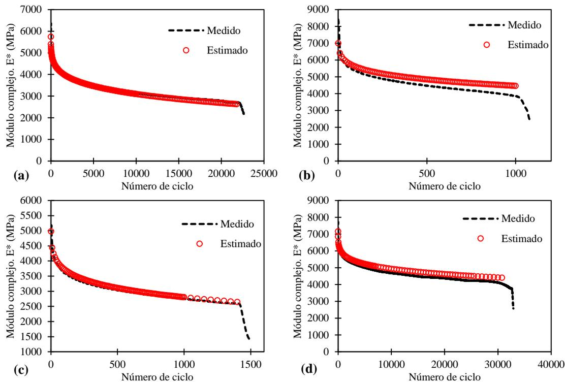
**Figura 4-14.** Comparación del comportamiento de los ensayos COS medidos y estimados a una frecuencia de 10 Hz para: (a) PG64-16\_F(19), (b) TER76E\_E(19), (c) SBS76V-22\_F(19), y (d) TER76E-22\_E(22)
