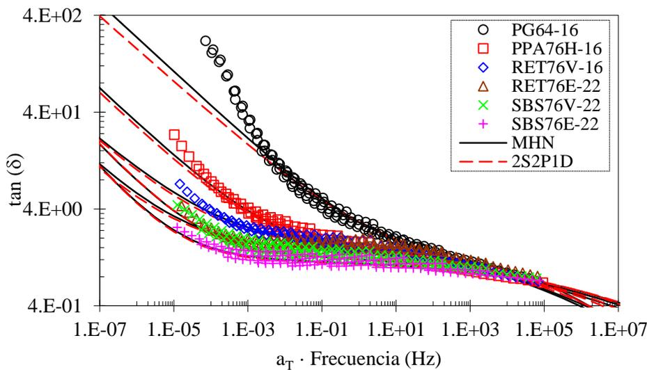
**Figura 2-9.** Valores de  $\tan \delta$  obtenidos con los modelos *2S2PID* y *MHN*
