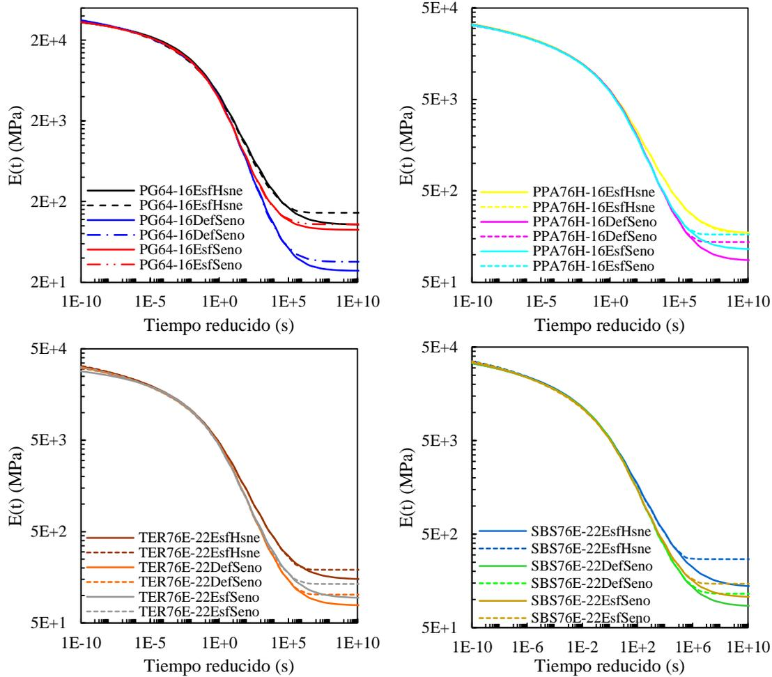
**Figura 3-11.** Curvas maestras del módulo de relajación construidas a una temperatura de referencia de 20°C para las distintas condiciones de ensayo (*EsfHsne*, *DefSeno* y *EsfSeno*) de las mezclas fabricadas con los asfaltos: (a) PG64-16, (b) PPA76H-16, (c) TER76E-16, y (d) SBS76E-22.
