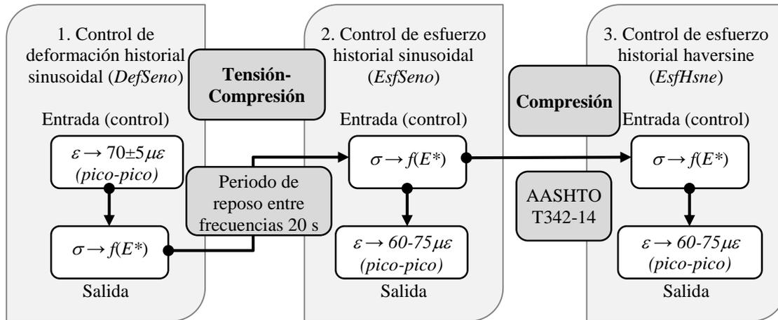
**Figura 3-4.** Diagrama del procedimiento experimental
