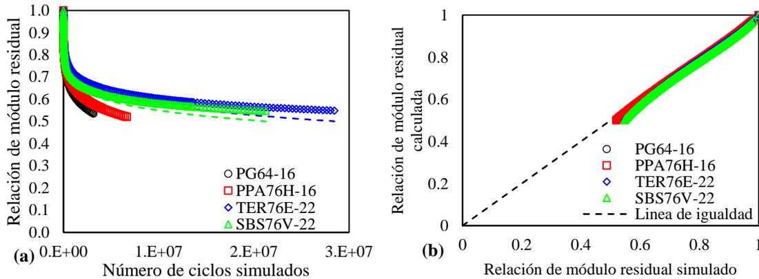
**Figura 5-11.** (a) Curvas de reducción de rigidez simuladas con el modelo S-VECD y (b) comparación entre la relación de la rigidez medida y calculada
