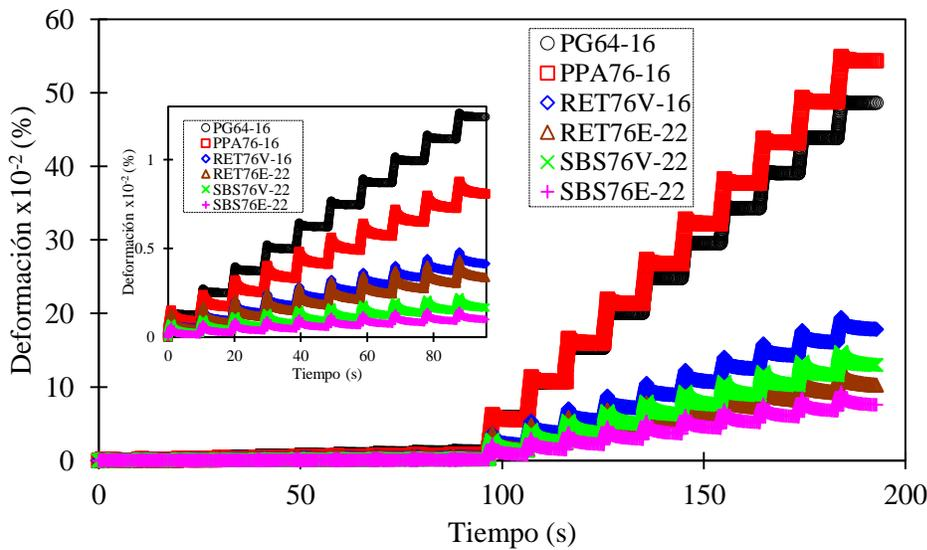
**Figura 2-10.** Fluencia y recuperación a 0.1 kPa y 3.2 kPa para los asfaltos en estudio
