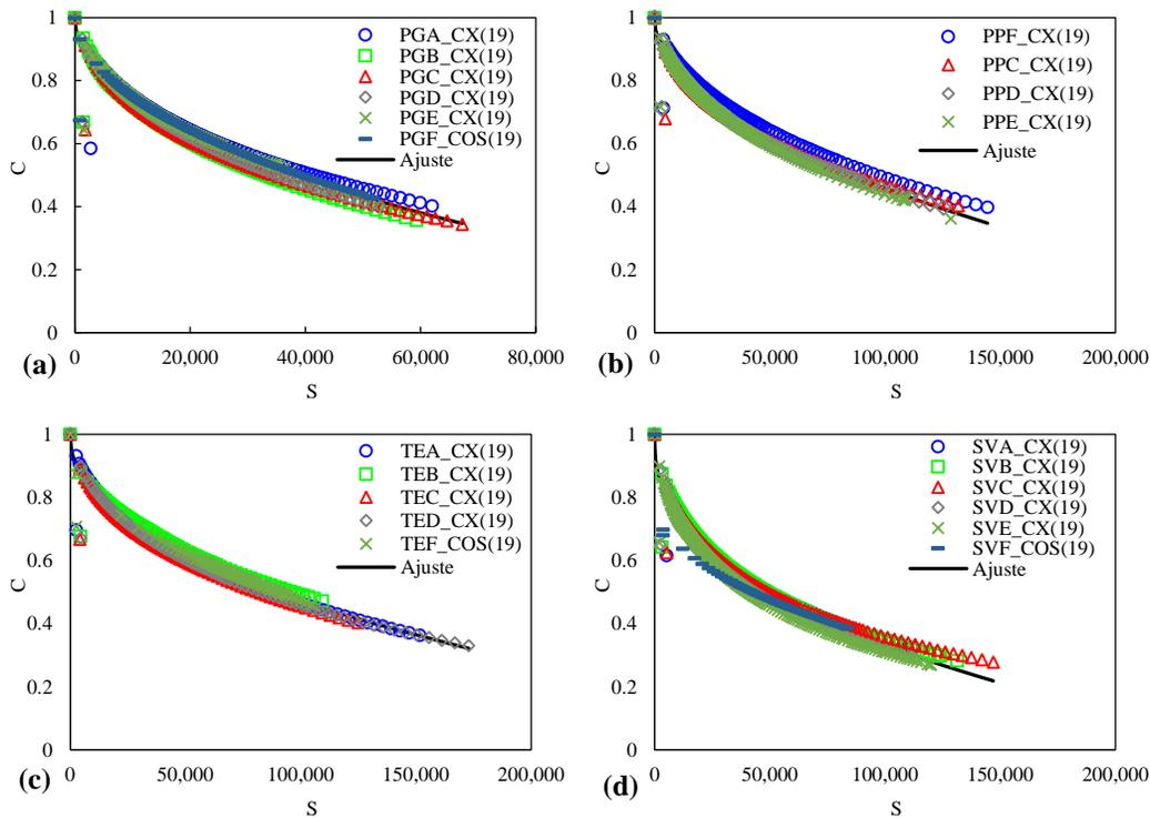
**Figura 4-9.** Relación de pseudo-rigidez versus parámetro de daño obtenida en especímenes de 70 mm de diámetro para las mezclas asfálticas fabricadas con los asfaltos: (a) convencional, (b) modificado con PPA, (c) modificado con Terpolímero y (d) modificado con SBS
