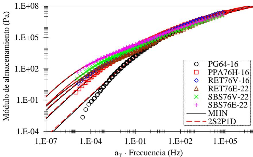
**Figura 2-5.** Curvas maestras del módulo de almacenamiento a una temperatura de referencia de  $40^\circ\text{C}$ , ajustadas con los modelos *2S2P1D* y *MHN*
