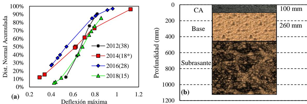
**Figura 5-5.** Deflexiones de superficie obtenidas durante las campañas de auscultación y espesores de la estructura de pavimento de la sección de estudio
