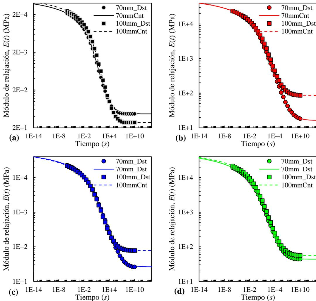
**Figura 4-7.** Curvas maestras del módulo de relajación para una temperatura de referencia de 20 °C, obtenidas en especímenes de 100 mm y 70 mm de diámetro para las mezclas fabricadas con los asfaltos: (a) convencional, (b) modificado con PPA, (c) modificado con TER y (4) modificado con SBS
