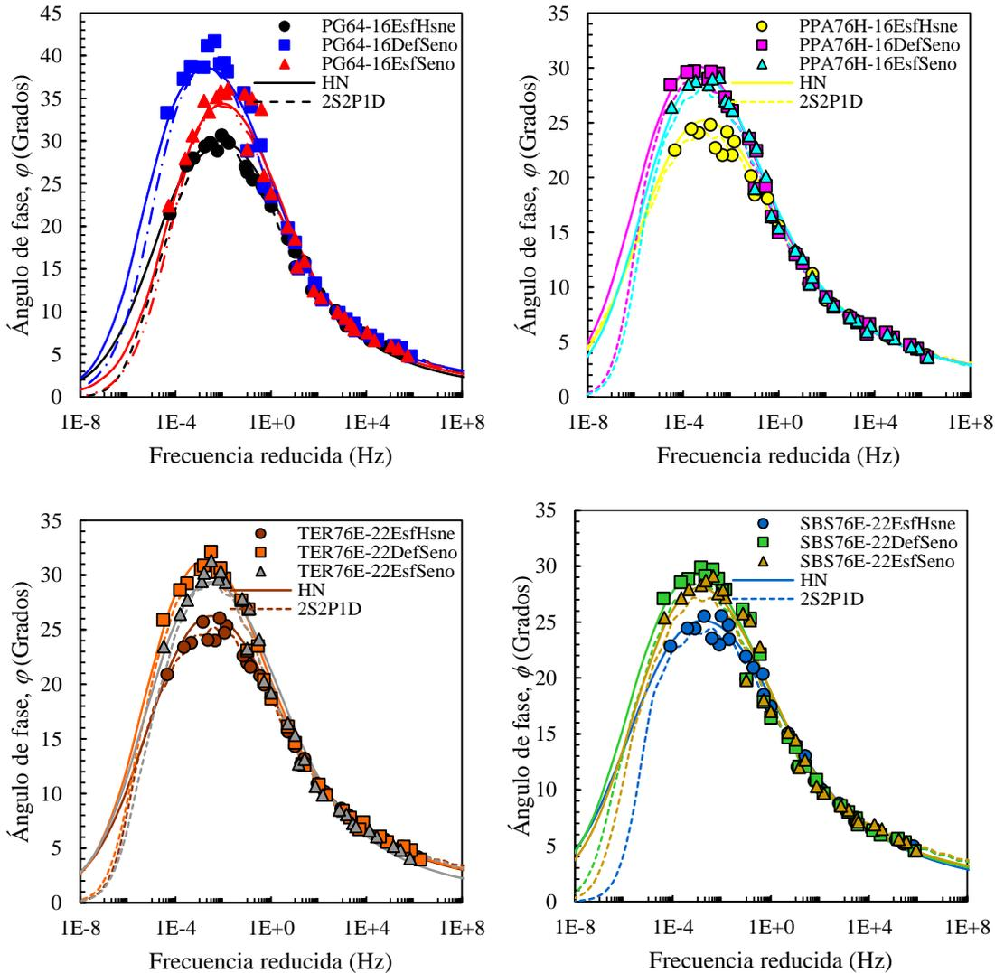
**Figura 3-14.** Curvas maestras del ángulo de fase obtenidas a través del espectro de relajación construidas a una temperatura de referencia de 20°C para las distintas condiciones de ensayo (*EsfHsne*, *DefSeno* y *EsfSeno*) de las mezclas fabricadas con los asfaltos: (a) PG64-16, (b) PPA76H-16, (c) TER76E-16, y (d) SBS76E-22.
