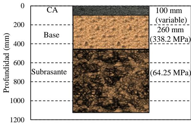
**Figura 5-9.** Módulos elásticos de las capas no estabilizadas de la estructura de pavimento de la sección de estudio
