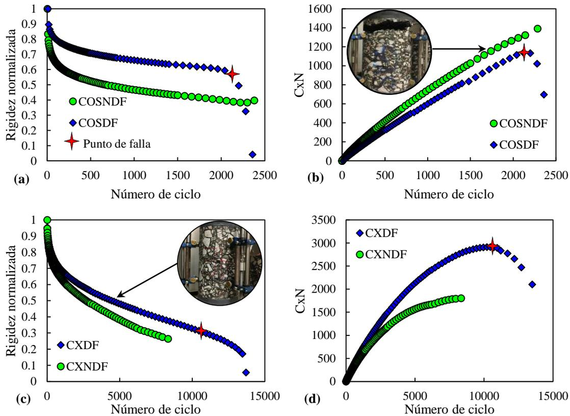
**Figura 4-12.** Criterio de falla experimental con gráficas de reducción de la rigidez normalizada para los ensayos: (a) deformación controlada en el espécimen y (c) control de desplazamiento del actuador; y con las gráficas de pseudo-rigidez por el número de ciclo versus el número de ciclos del ensayo: (b) deformación controlada en el espécimen y (d) control de desplazamiento del actuador
