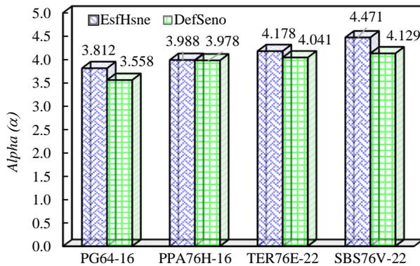
**Figura 4-17.** Variación de alfa con respecto al tipo de control de ensayo.
