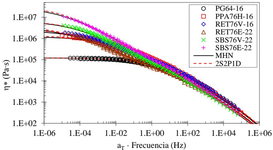
**Figura 2-6.** Curvas maestras de la viscosidad compleja a una temperatura de referencia de 40 °C, ajustadas con los modelos 2S2P1D y MHN.
