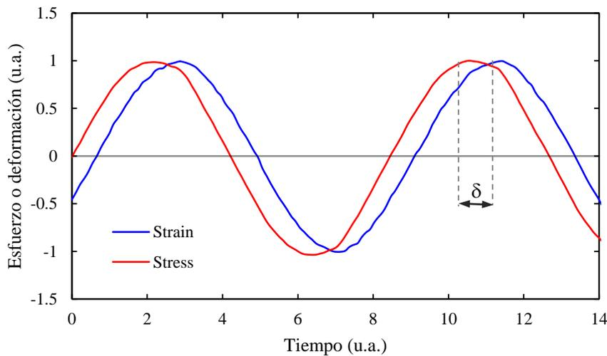
**Figura 2-1.** Función del esfuerzo ( $\tau$ ) y función de la deformación ( $\gamma$ ) resultante con unidades arbitrarias (*u.a.*)
