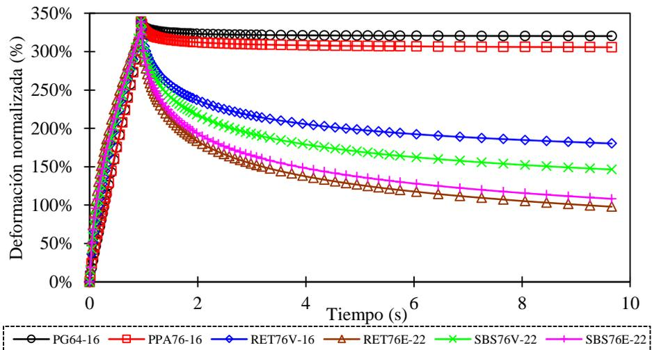
**Figura 2-12.** Deformación normalizada y recuperación para el ciclo 20 a 3.2 kPa
