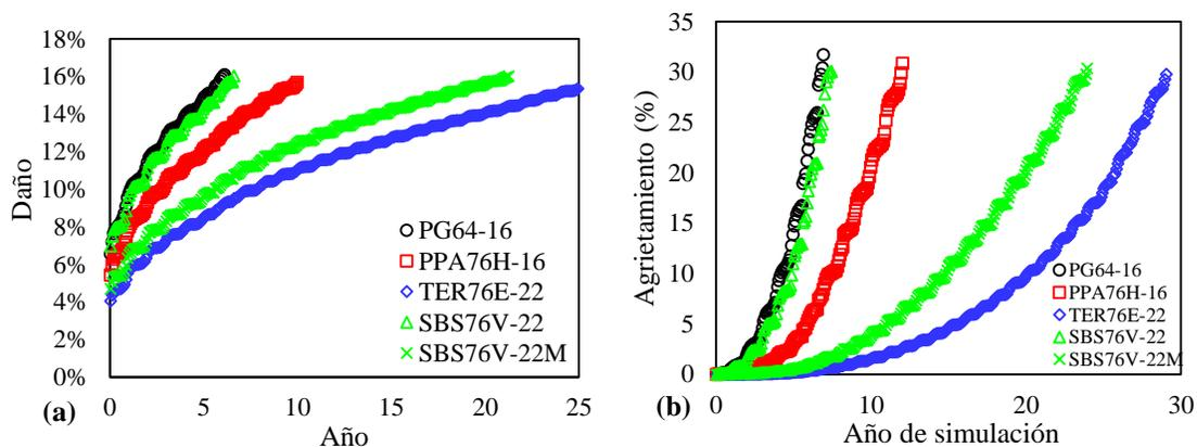
**Figura 5-13.** (a) Daño y agrietamiento obtenidos de las simulaciones realizadas en CalME para la sección de estudio y las distintas mezclas asfálticas.
