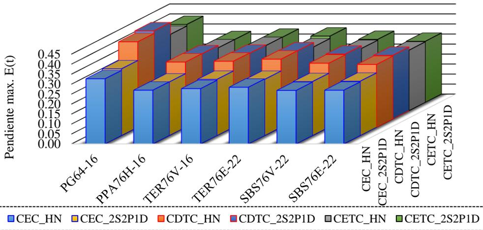
**Figura 3-12.** Pendiente máxima de las curvas maestras del módulo de relajación de los asfaltos en estudio por tipo de ensayo.
