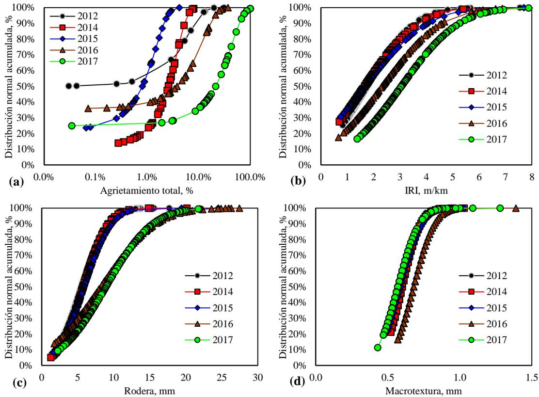
**Figura 5-7.** Características de superficie de la sección de estudio del año 2012 al año 2017: (a) agrietamiento, (b) IRI, (c) profundidad de rodera y (d) macrotextura
