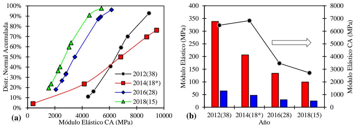
**Figura 5-6.** Distribución normal acumulada de los módulos elásticos del concreto asfáltico normalizados a 20 °C y promedio de los módulos elásticos de las distintas capas del pavimento
