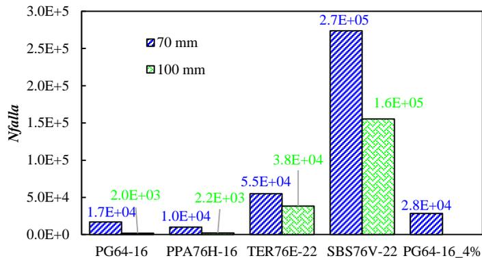
**Figura 4-16.** Comparación de la vida a fatiga para un nivel de deformación de  $400 \mu\epsilon$ , de las distintas geometrías de ensayo para las mezclas asfálticas en estudio
