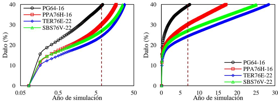
**Figura 5-20.** Porcentaje de daño simulado con FlexPAVE™ usando un eje de diseño de 52 kN de carga para las diferentes mezclas en la estructura de pavimento de la sección de estudio en: (a) escala semilogarítmica y (b) escala aritmética
