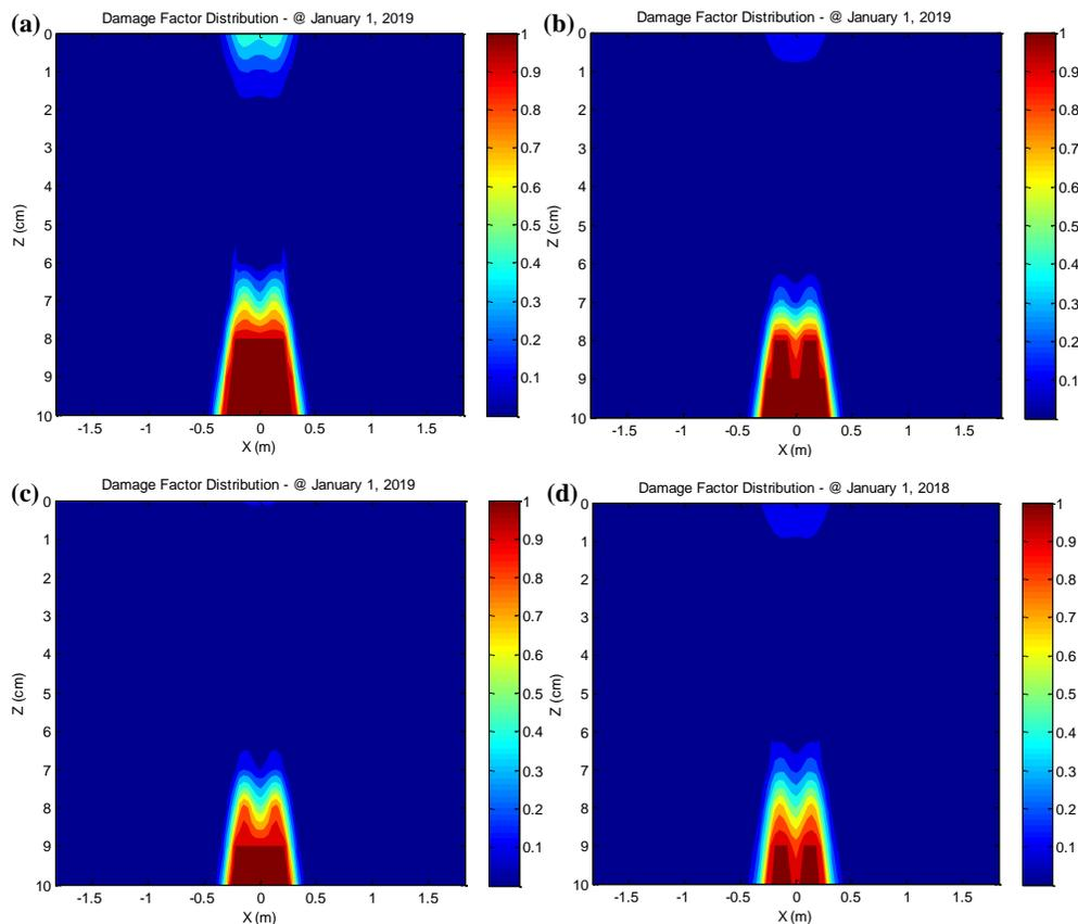
**Figura 5-17.** Contornos de daño de la sección de estudio para 7 años de simulación obtenidos con FlexPAVE™ para las mezclas asfálticas fabricadas con los siguientes asfaltos:(a) PG64-16, (b) PPA76H-16, (c) TER76E-22 y (d) SBS76V-22
