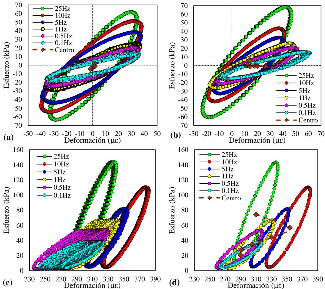
**Figura 3-6.** Variación del lazo de histéresis con la frecuencia a una temperatura de ensayo de 54 °C en un espécimen de concreto asfáltico fabricado con asfalto modificado SBS (SBS76E-22\_5) para las distintas condiciones de ensayo: (a) control-deformación (*DefSeno*), (b) control-esfuerzo (*EsfSeno*), (c) control de esfuerzo en compresión (*EsfHsne*) últimos diez ciclos y (d) control de esfuerzo en compresión (*EsfHsne*) promedio de los últimos diez ciclos
