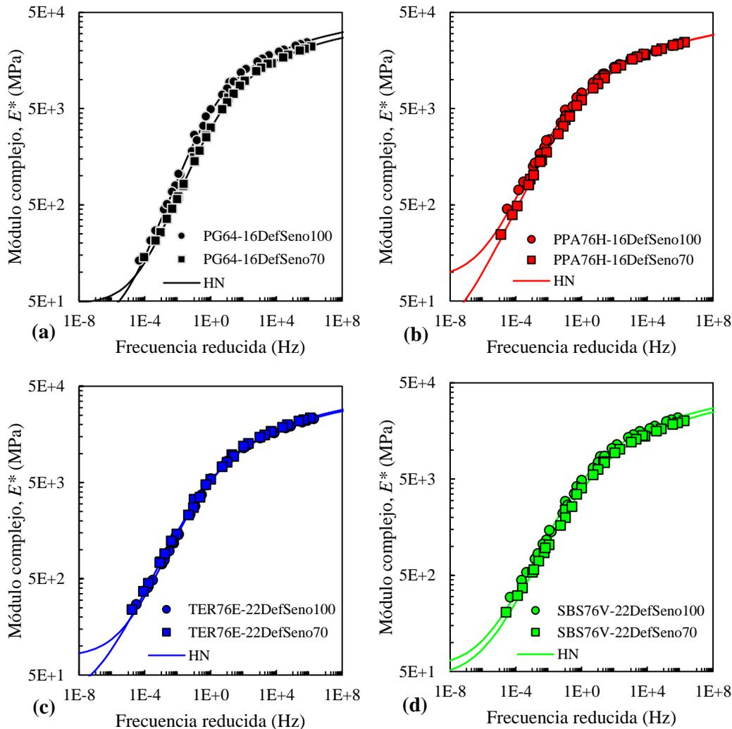
**Figura 4-4.** Curvas maestras del módulo complejo de Young para una temperatura de referencia de 20 °C, obtenidas en especímenes de 100 mm y 70 mm de diámetro para las mezclas fabricadas con los asfaltos: (a) convencional, (b) modificado con PPA, (c) modificado con TER y (d) modificado con SBS
