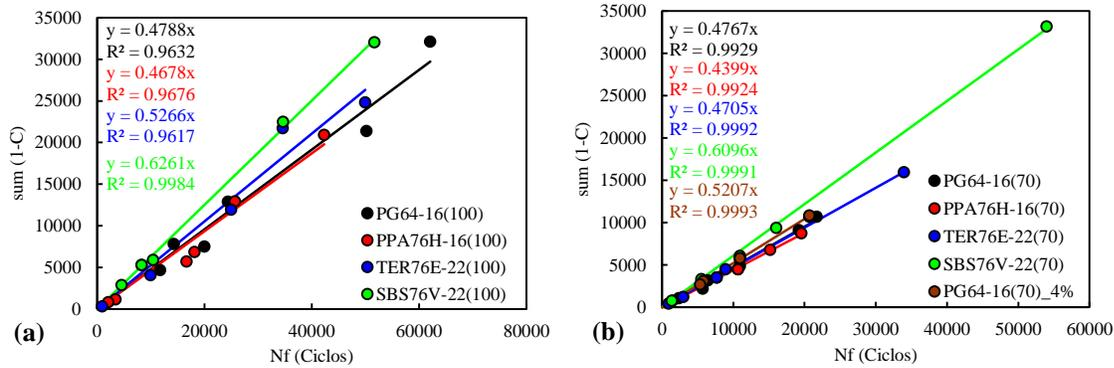
**Figura 4-13.** Relación de la acumulación de la pseudo-rigidez a la falla ( $\text{sum}(1-C)$ ) versus el número de ciclos a la falla de las mezclas en estudio para: (a) especímenes de 100 mm de diámetro y (b) especímenes de 70 mm de diámetro
