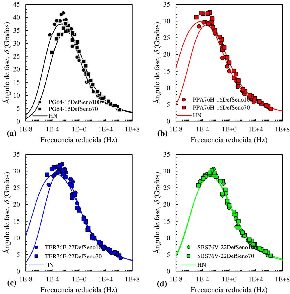
**Figura 4-5.** Curvas maestras del ángulo de fase para una temperatura de referencia de 20 °C, obtenidas en especímenes de 100 mm y 70 mm de diámetro para las mezclas fabricadas con los asfaltos: (a) convencional, (b) modificado con PPA, (c) modificado con TER y (4) modificado con SBS
