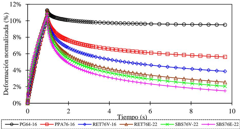
**Figura 2-11.** Deformación normalizada y recuperación para el ciclo 10 a 0.1 kPa
