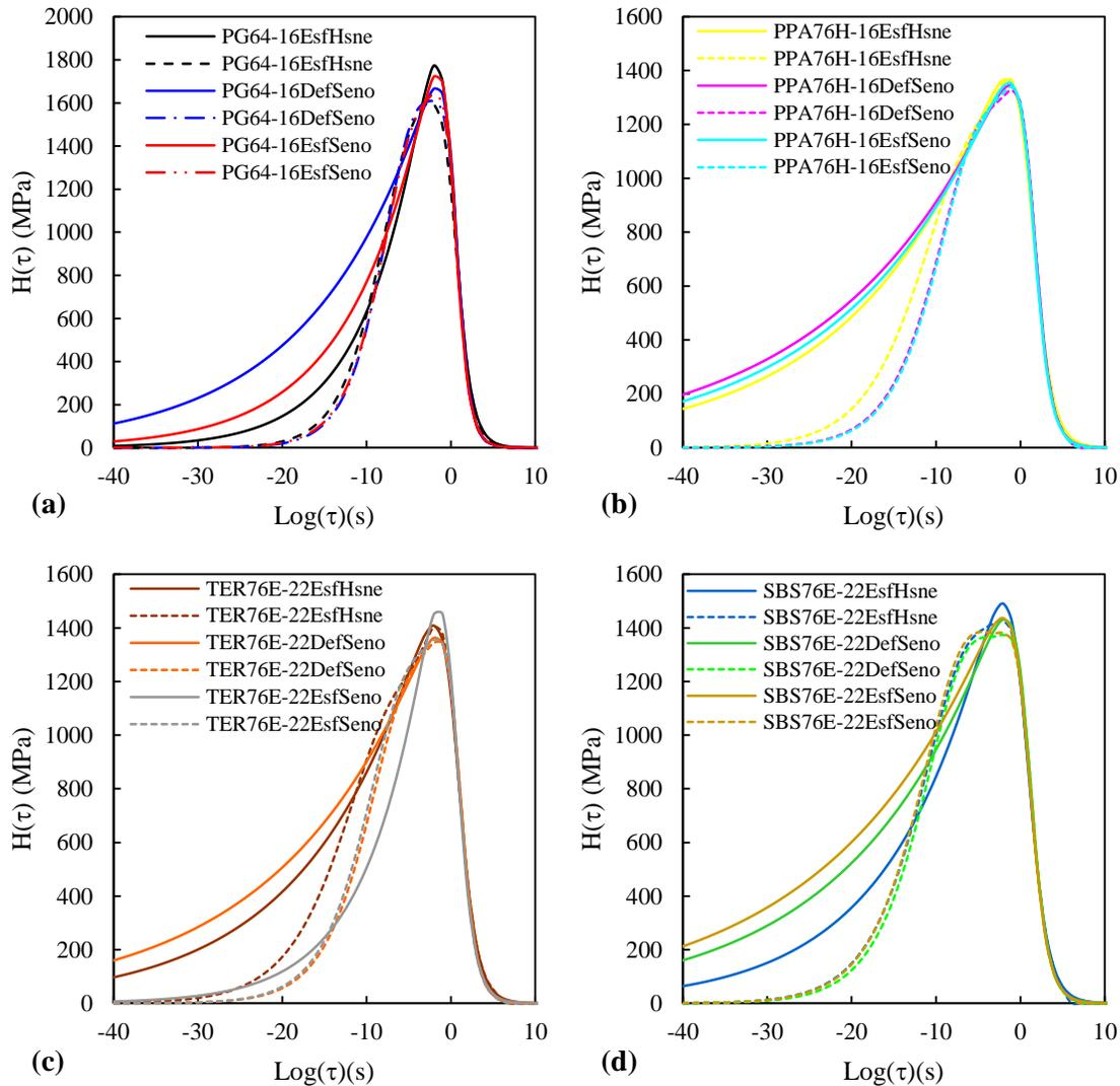
**Figura 3-10.** Espectros de relajación continuos para las distintas condiciones de ensayo (*EsfHsne*, *DefSeno* y *EsfSeno*) de las mezclas fabricadas con los asfaltos: (a) PG64-16, (b) PPA76H-16, (c) TER76E-16, y (d) SBS76E-22.
