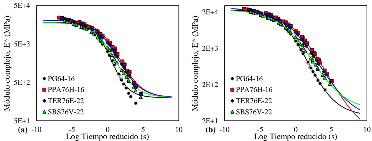
**Figura 5-10.** Curvas maestras ajustadas a una temperatura de referencia de 20°C de las mezclas asfálticas en estudio: (a) definiendo y fijando el valor mínimo de la curva maestra en 200 MPa y (a) ajustando libremente todos los parámetros del modelo de la curva maestra
