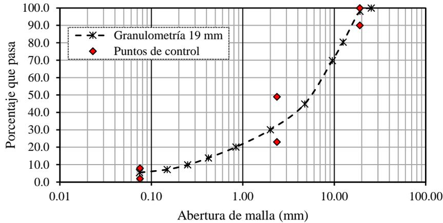
**Figura 3-1.** Curva granulométrica de diseño para las mezclas asfálticas evaluadas
