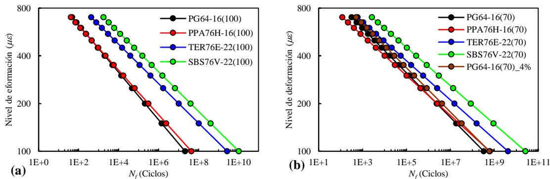
**Figura 4-15.** Simulación de la vida a fatiga utilizando el criterio de falla  $D^R$  a 20°C y 10 Hz de las mezclas en estudio para: (a) especímenes de 100 mm de diámetro y (b) especímenes de 70 mm de diámetro
