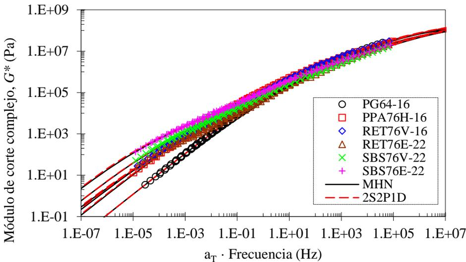
**Figura 2-4.** Curvas maestras del módulo de corte complejo a una temperatura de referencia de  $40^\circ\text{C}$ , ajustadas con los modelos *2S2P1D* y *MHN*
