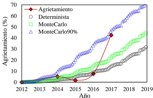
**Figura 5-15.** Comparación entre el agrietamiento calculado y observado en la sección de estudio
