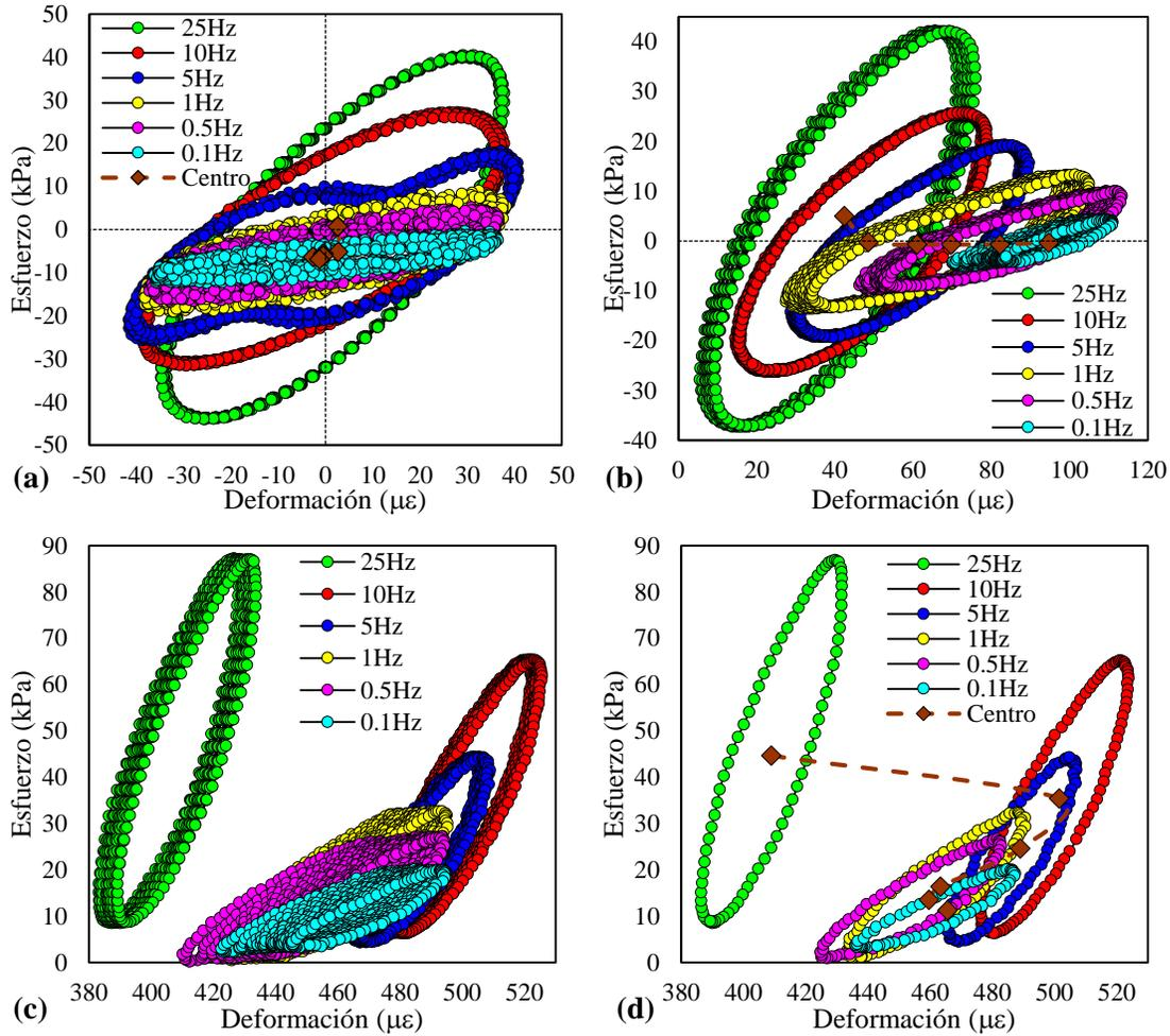
**Figura 3-5.** Variación del lazo de histéresis con la frecuencia a una temperatura de ensayo de 54 °C en un espécimen de concreto asfáltico fabricado con asfalto convencional (PG64-16\_2) para las distintas condiciones de ensayo: (a) control-deformación (*DefSeno*), (b) control-esfuerzo (*EsfSeno*), (c) control de esfuerzo en compresión (*EsfHsne*) para los últimos diez ciclos y (d) control de esfuerzo en compresión (*EsfHsne*) promedio de los últimos diez ciclos
