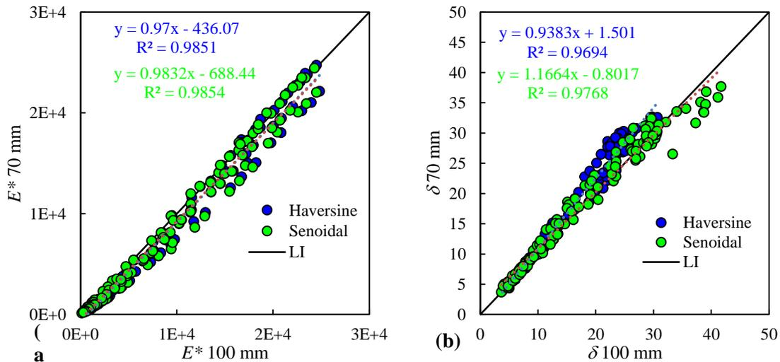
**Figura 4-6.** Comparación de resultados obtenidos para especímenes de 100 mm vs 70 mm para: (a) módulo complejo de Young y (b) ángulo de fase
