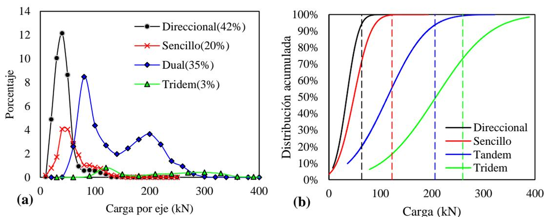
**Figura 5-3.** (a) Distribución de la carga por tipo de eje y (b) distribución normal acumulada por tipo de eje
