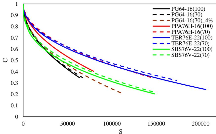
**Figura 4-11.** Comparación de la relación de pseudo rigidez versus parámetro de daño para las distintas geometrías de ensayo y mezclas asfálticas
