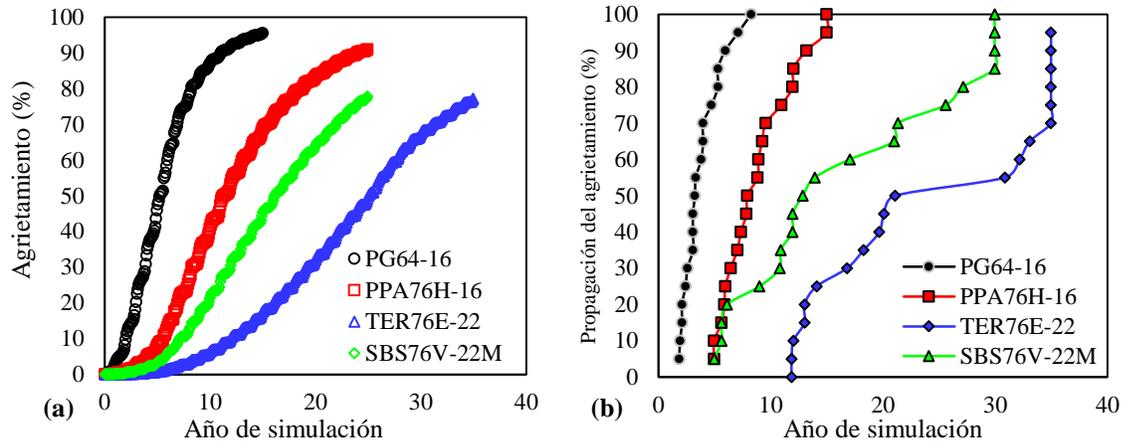
**Figura 5-14.** Resultados del análisis probabilista realizado en CalME para las distintas mezclas en estudio de: (a) agrietamiento y (b) propagación del agrietamiento
