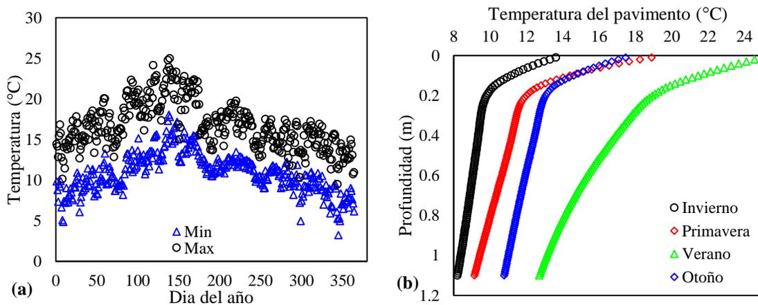
**Figura 5-4.** (a) Temperatura máxima-mínima y (b) gradiente de temperatura con la profundidad del pavimento estimada para el año 2012
