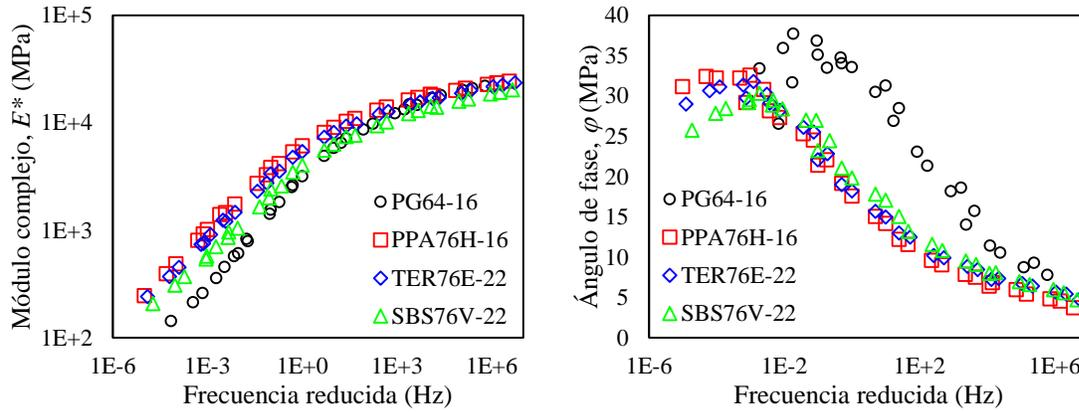
**Figura 5-12.** Curvas maestras construidas a una temperatura de referencia de 20 °C de: (a) módulo complejo y (b) ángulo de fase
