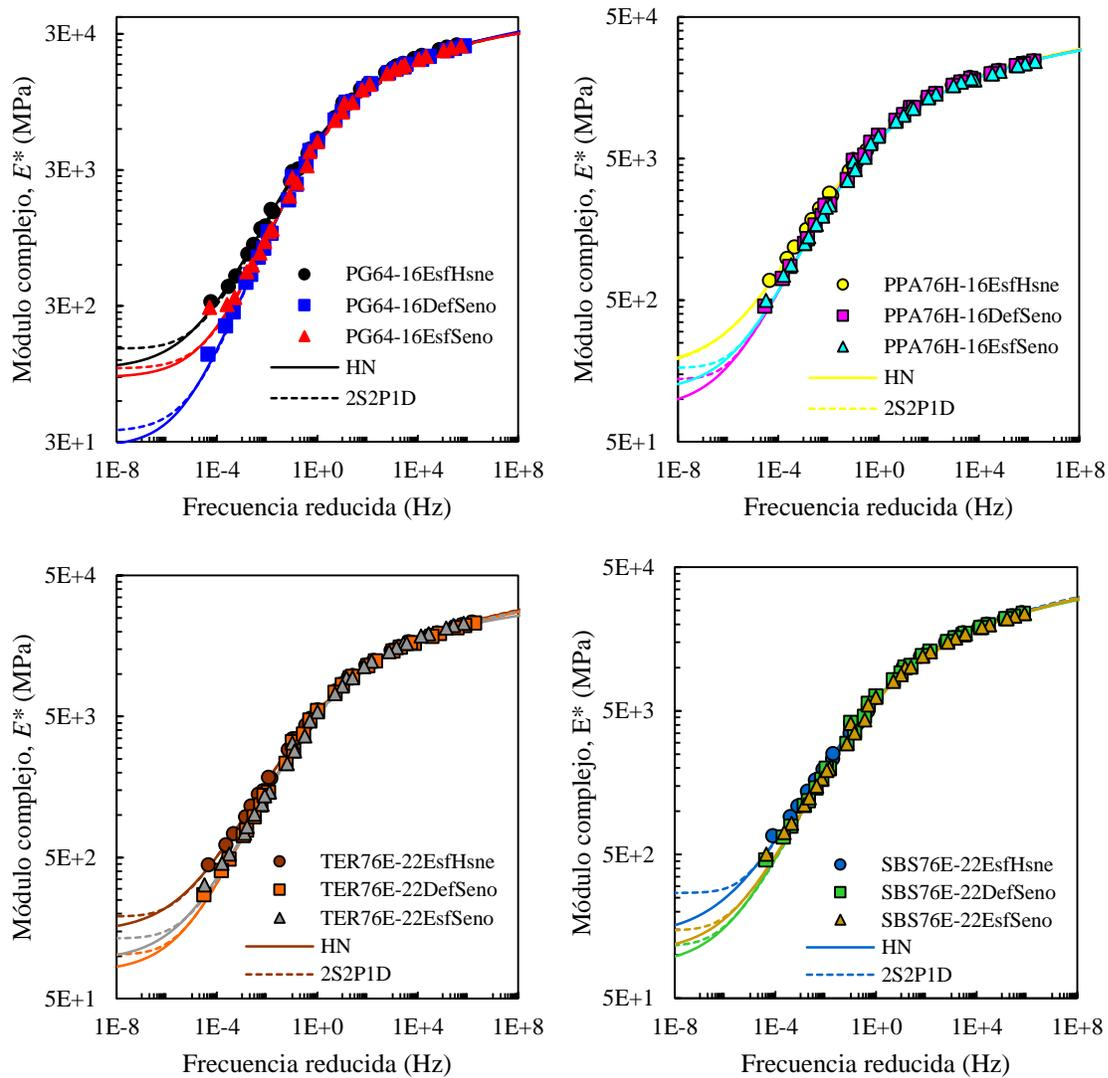
**Figura 3-13.** Curvas maestras del módulo complejo de Young obtenidas a través del espectro de relajación construidas a una temperatura de referencia de 20°C para las distintas condiciones de ensayo (*EsfHsne*, *DefSeno* y *EsfSeno*) de las mezclas fabricadas con los asfaltos: (a) PG64-16, (b) PPA76H-16, (c) TER76E-16, y (d) SBS76E-22.
