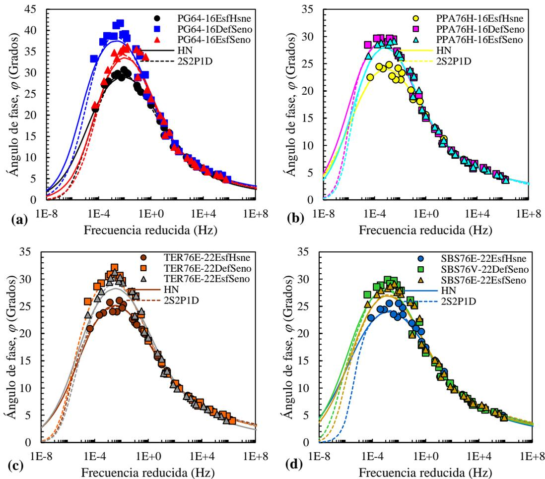
**Figura 3-8.** Curvas maestras del ángulo de fase ( $\varphi$ ) construidas a una temperatura de referencia de 20°C para las distintas condiciones de ensayo (*EsfHsne*, *DefSeno* y *EsfSeno*) de las mezclas fabricadas con los asfaltos: (a) PG64-16, (b) PPA76H-16, (c) TER76E-16, y (d) SBS76E-22.
