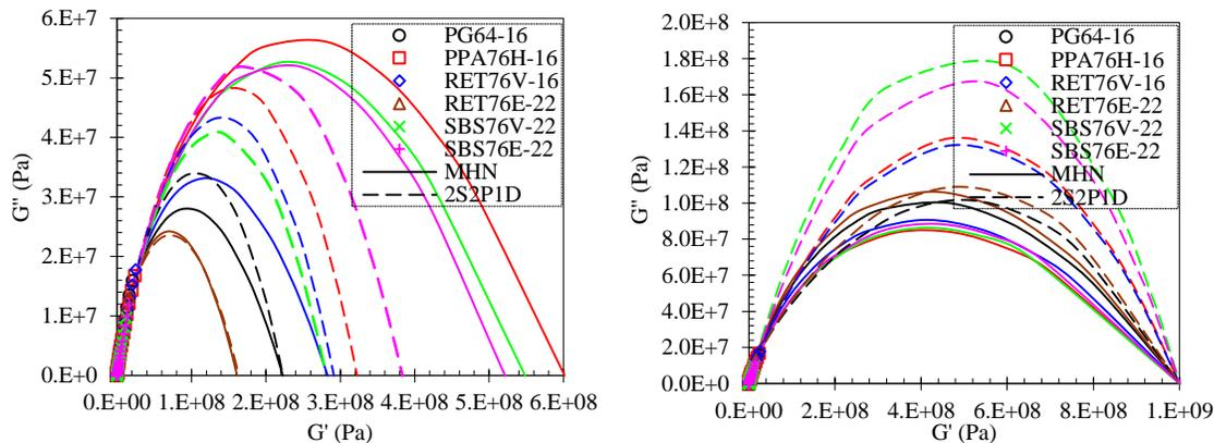
**Figura 2-8.** Plano de Cole-Cole de los distintos asfaltos en estudio obtenido con los modelos *2S2PID* y *MHN*, y calculados con las siguientes variantes: (a) permitiendo que  $G_g$  se modifique durante la optimización y (b) fijando el valor de  $G_g$  a 1GPa sin permitir que se modifique durante la optimización
