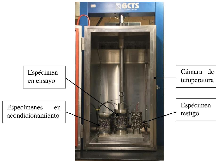
**Figura 3-2.** Ensayo de especímenes usando el equipo ATM-025
