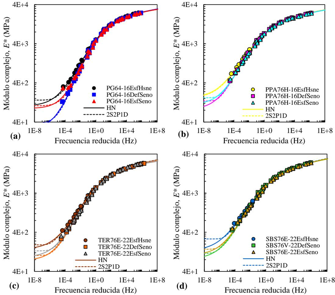
**Figura 3-7.** Curvas maestras del módulo complejo ( $E^*$ ) construidas a una temperatura de referencia de  $20^\circ\text{C}$  para las distintas condiciones de ensayo ( $EsfHsne$ ,  $DefSeno$  y  $EsfSeno$ ) de las mezclas fabricadas con los asfaltos: (a) PG64-16, (b) PPA76H-16, (c) TER76E-16, y (d) SBS76E-22.
