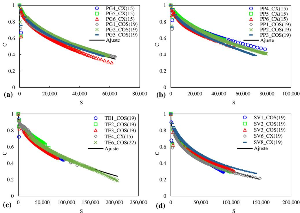
**Figura 4-8.** Relación de pseudo-rigidez versus parámetro de daño obtenida en especímenes de 100 mm de diámetro para las mezclas asfálticas fabricadas con los asfaltos: (a) convencional, (b) modificado con PPA, (c) modificado con Terpolímero y (d) modificado con SBS
