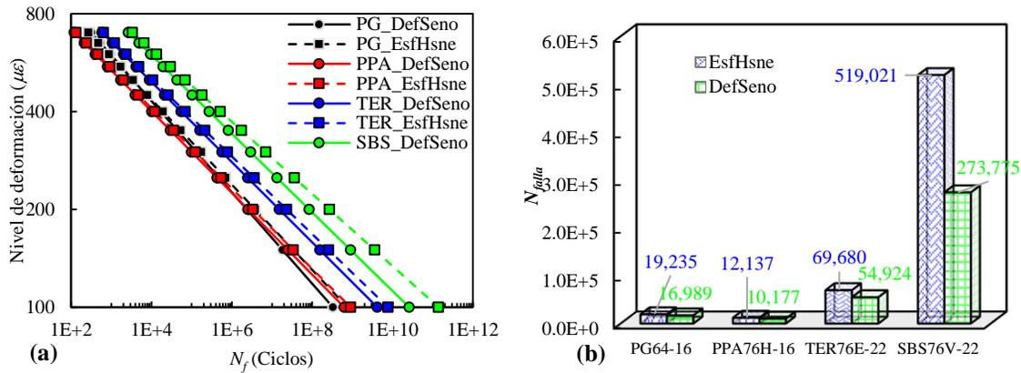
**Figura 4-18.** Comparación de vida a fatiga utilizando los distintos valores de alfa obtenidos con los dos modos de control de ensayo para: (a) todo el rango de niveles de deformación y (b) para un nivel de deformación de  $400 \mu\epsilon$ .
