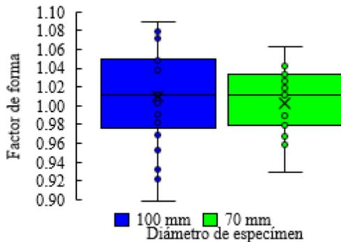
**Figura 4-10.** Diagramas de caja y bigotes del factor de forma de las curvas características con respecto a los diferentes diámetros de los especímenes
