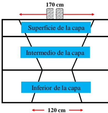
**Figura 5-16.** Área de referencia para la definición del porcentaje de daño en FlexPAVE™
