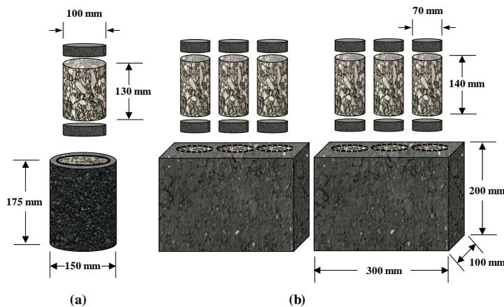
**Figura 4-1.** Preparación de los especímenes de ensayo fabricados con: (a) compactador giratorio y (b) compactador de rodillo
