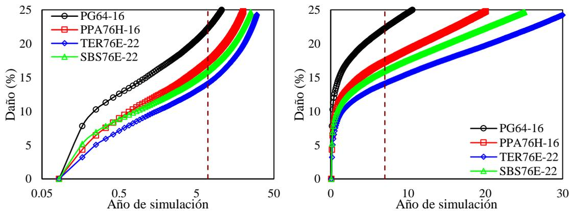
**Figura 5-18.** Porcentaje de daño simulado con FlexPAVE™ para las diferentes mezclas en estudio en la estructura de pavimento representadas en: (a) escala semilogarítmica y (b) escala aritmética
