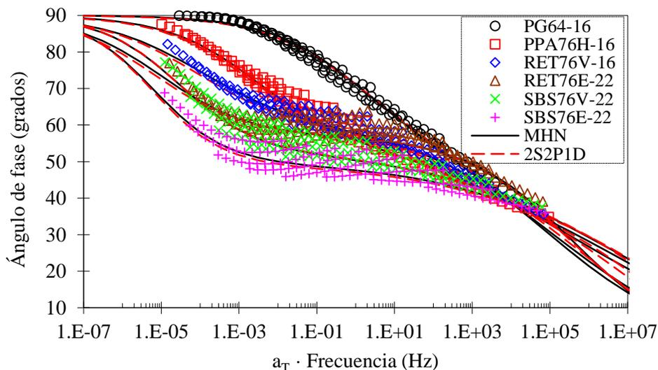
**Figura 2-7.** Curvas maestras del ángulo de fase a una temperatura de referencia de 40°C, ajustadas con los modelos *2S2PID* y *MHN*
