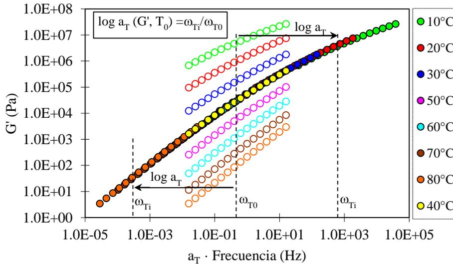
**Figura 2-2.** Representación esquemática del principio de superposición tiempo-temperatura
