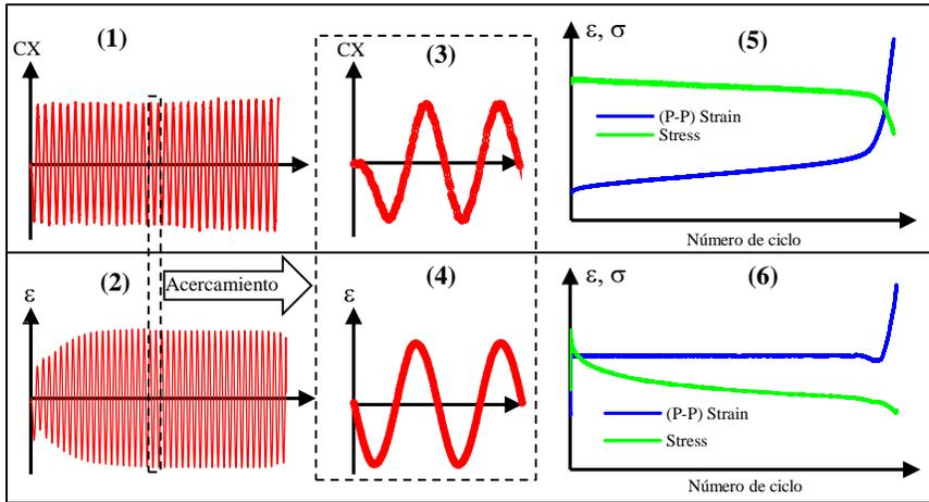
**Figura 4-3.** Diagrama de los modos de control de ensayo: (1) desplazamiento del actuador (CX) y (2) deformación en el espécimen (COS); acercamiento para un ciclo de carga: (3) CX y (4) COS; historiales de esfuerzo-deformación: (5) CX y (6) COS
