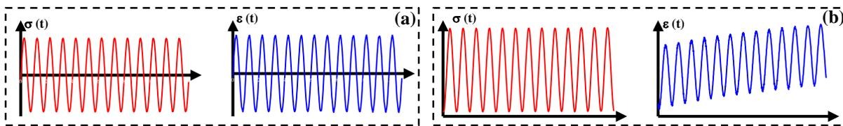
**Figura 4-2.** Representación del historial de carga para los distintos ensayos de módulo complejo: (a) sinusoidal y (b) haversine
