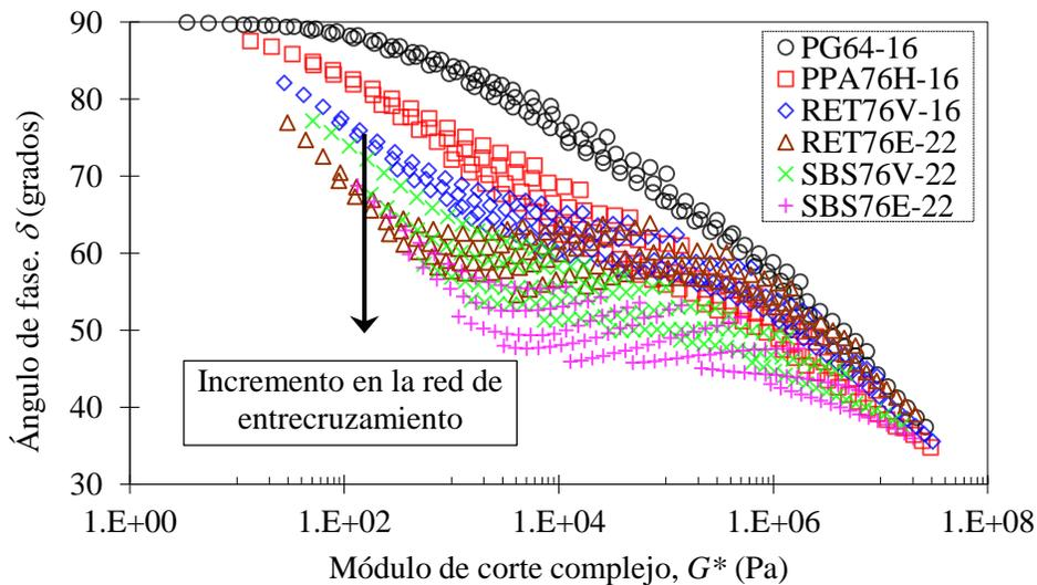
**Figura 2-3.** Diagrama de Black mostrando como los asfaltos modificados se alejan del comportamiento termo-reológico simple
